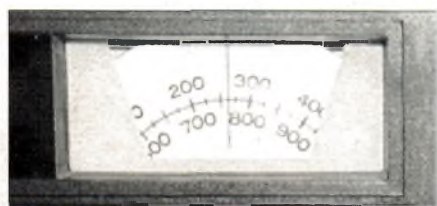
Avant l'affichage digital, on faisait appel à un système de cadran circulaire comme sur cet ancien FT-277E.
