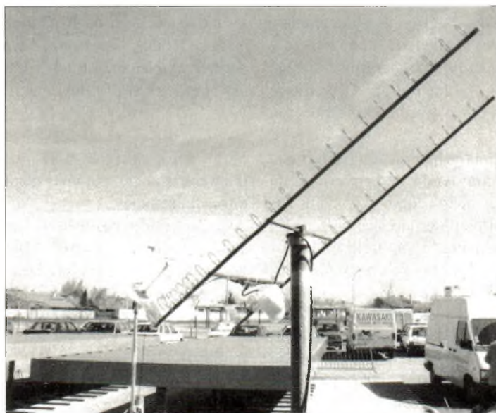
Des antennes pour recevoir les satellites en 1200 MHz.
