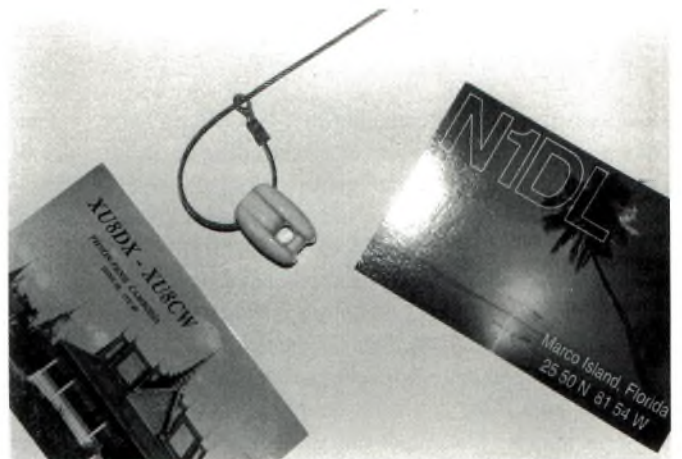
Pour un petit dipôle un système de fixation du fil comme celui-ci suffit.
