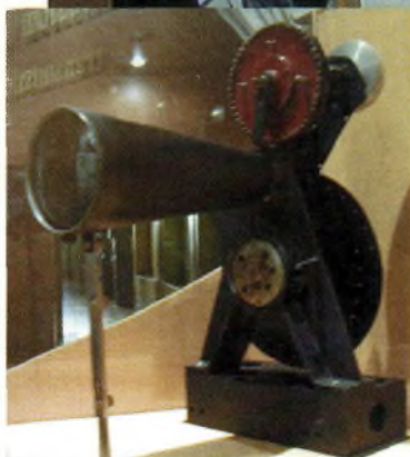
L'un des tous premiers récepteurs de télévision en 1932 basé sur le principe de la roue de Nipkow.
