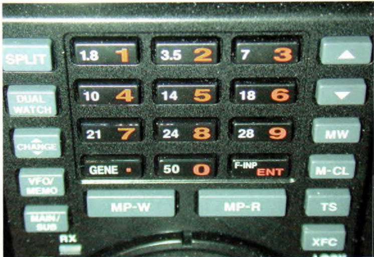
Le clavier permet de rentrer facilement les fréquences ou de changer de bandes.
