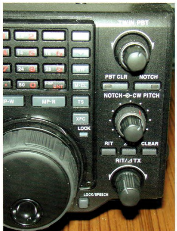
Un notch automatique et un double réglage des filtres DSP.
