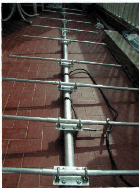
L'antenne montée par terre, sur le deuxième élément on distingue le gamma match.
