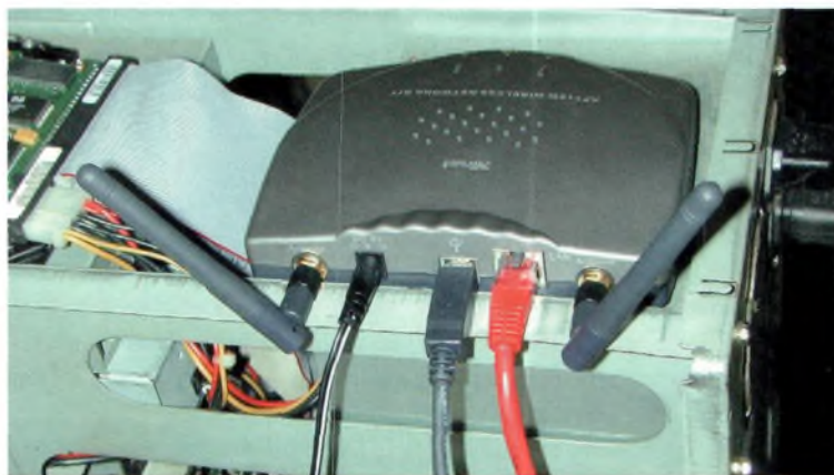
La face arrière de la borne WiFi avec ses 2 antennes sur SMA, RJ45 et USB.
