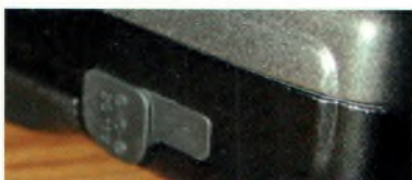
Une vue classique si ce n'est que la touche « MONI » sous le PTT qui sert à passer d'une fréquence à l'autre (VFO A & B) en mode cross-band.
