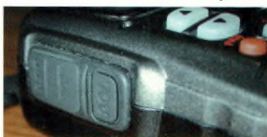
Une vue classique si ce n'est que la touche « MONI » sous le PTT qui sert à passer d'une fréquence à l'autre (VFO A & B) en mode cross-band.
