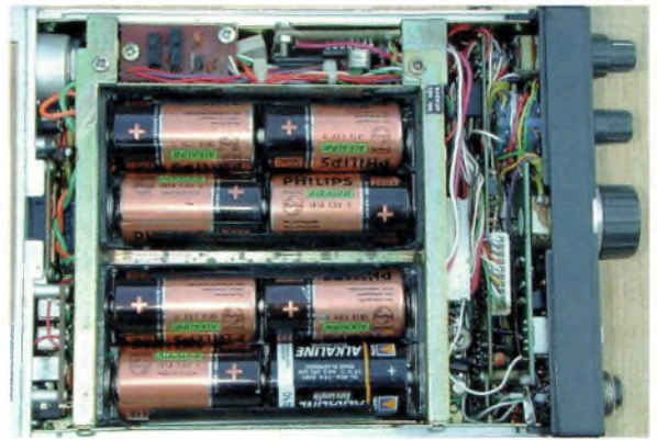
Piles ou accu, le choix était permis. En revanche, dans ces conditions la puissance de sortie était limitée, les 2.5 à 3 watts n'étant atteint que sous une tension de 13.8 volts.
