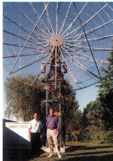
Bertrand, F5PL, à gauche, reçoit la balise EME de W2ETI, via la lune donc, avec cette parabole de 7 mètres de diamètre. A gauche, Hopkins, N6BQ, est également un pratiquant assidu de l'EME sur 1296 MHz. (crédit photo F5PL).
