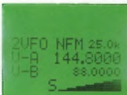
Le Smètre n'en est pas un, il s'agit d'un indicateur relatif du niveau d'entrée.
