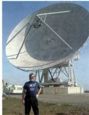
Cette parabole totalise 32 mètres de diamètre. Elle est installée en Italie à l'institut de radioastronomie près de Bologne. Elle est équipée de récepteurs cryogéniques (voir le lexique) permettant les multiples réceptions de signaux compris entre 327 MHz et 43 GHz. Cela devrait plaire à certains !
