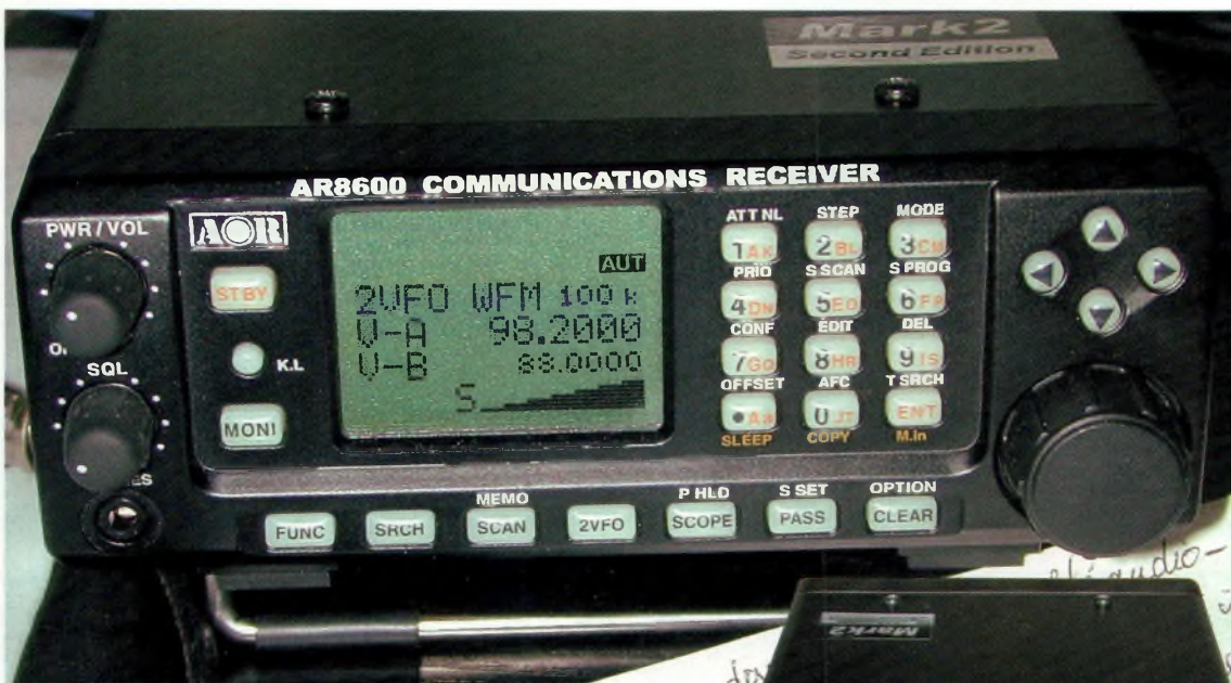
Le Smètre n'en est pas un, il s'agit d'un indicateur relatif du niveau d'entrée.
