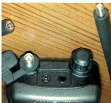
Connecteur SMA, accès pour micro-HP et antenne modulable selon les bandes 50 MHz ou au-dessus.
