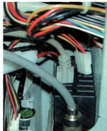
A la place d'un lecteur CD ou DD, un DR135 équipé de sa carte modem prend place. On voit les connectiques d'antenne et RS232.
