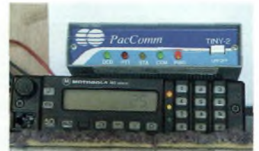
Un TNC, transceiver de récupération classique, et voilà un digipeater autonome.
