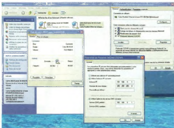
Voici la configuration réseau sous XP du PC ROUTEUR.
