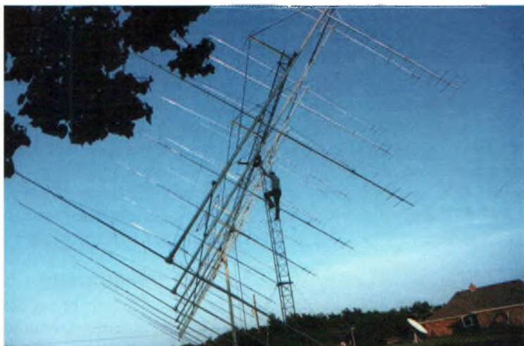
Le groupement d'antennes EME de W5UN pour la bande des 2 mètres. Si vous les comptez, vous trouverez 48 YAGI de 24 éléments !
