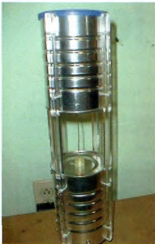
Une double-champs 20 m réalisée avec des boîtes de conserves de WOKPH.
