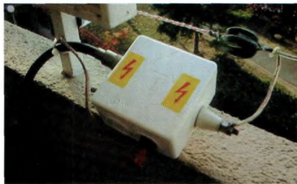
BALUN magnétique de l'antenne décamétrique.
