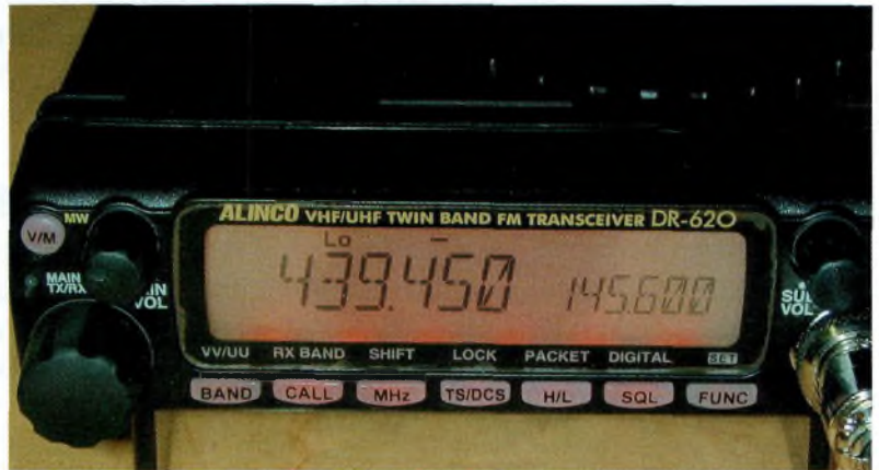
Les récepteurs permettent d'écouter 2 fréquences en VV, UU ou UV, mais si l'on passe en émission (439.450) la réception du 145.6 MHz se coupe.
