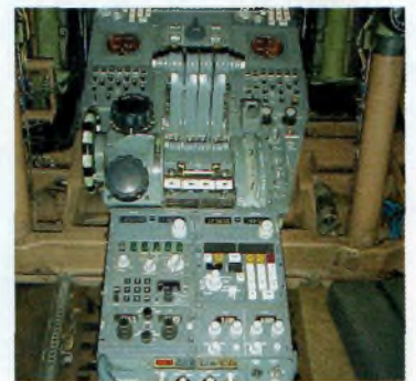
Commandes des gaz (console centrale)
