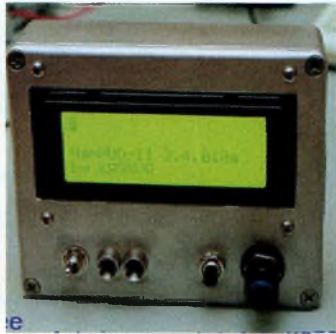
Un afficheur d'infos APRS à connecter à la sortie du TNC. Idéal pour le mobile.
