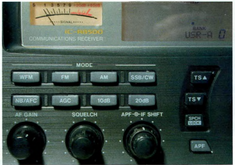
Un atténuateur de 10 ou 20 dB au cas où la présence de signaux vraiment trop forts viendrait saturer l'entrée.
