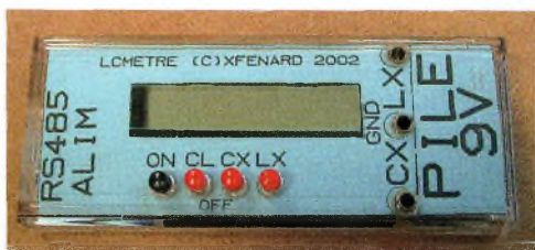
Le LCmètre avec son affichage LCD.
