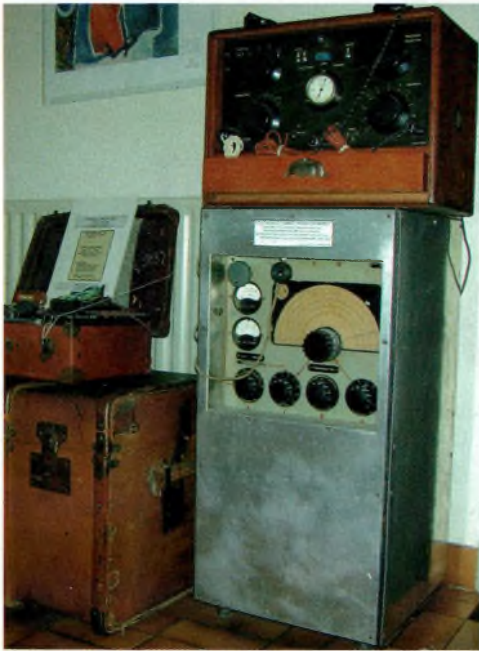
Dans la boîte métallique en aluminium se trouve un émetteur-récepteur radioamateur réalisé sur une base de matériel militaire.
