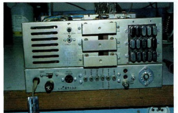
Notez la batterie de quartz sur cette face arrière (F6BIA)
