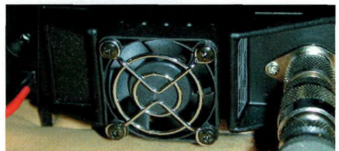
Le gros ventilateur reste assez discret. Notez à la verticale du cordon d'alim la prise jack 3.5. Elle sert au HP externe mais aussi à l'alarme. Celle-ci aurait du mal à réveiller un chat au soleil mais les bases sont là pour commander un autre dispositif plus persuasif.
