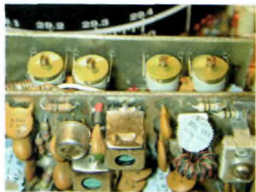
De l'électronique à la mécanique il n'y a qu'un pas. Ici la molette qui sert à faire tourner le tambour de l'affichage des fréquences.
