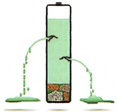
Figure 4 : Une batterie peut afficher un taux d'autodécharge progressif causé par une température élevée, par un nombre de cycle élevé, et par l'âge.
