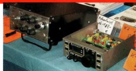
Le K1 Elecraft (frère jumeau du K2 mais uniquement cw). Tout est dans la boîte, rien ne manque !
