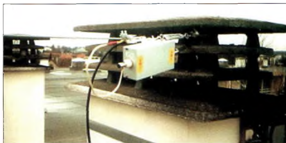
Photo 10, Antenne long fil sur le toit du QRA avec balun 9/1
