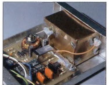
La partie RF est bien isolée du reste de l'électronique.
