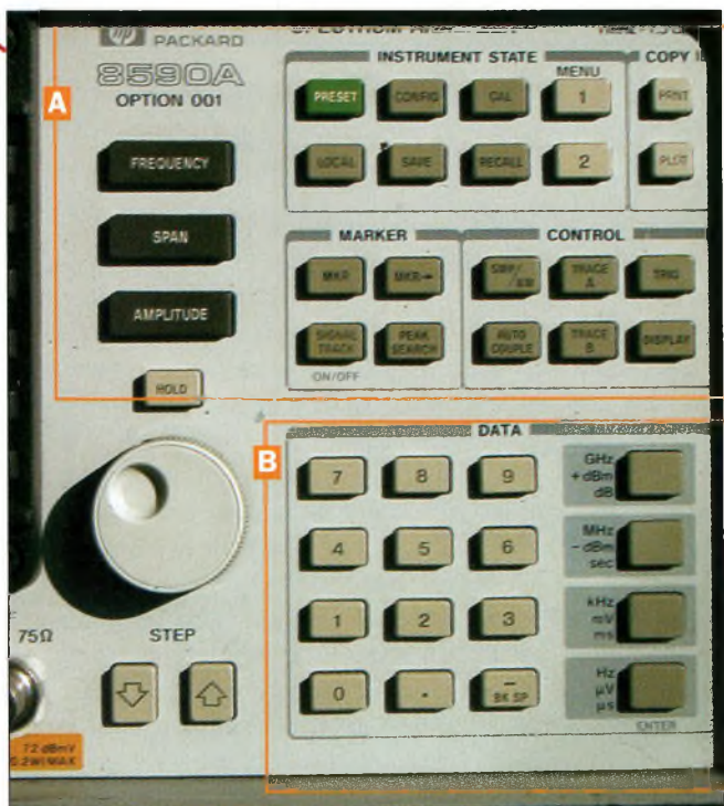
A. Il est possible d'afficher les niveaux en dBm, dBV et leurs sous multiples. B. Les fréquences se rentrent directement au clavier.
