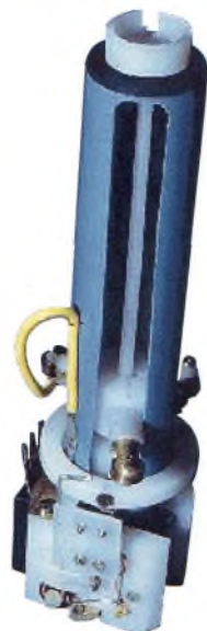
Le préassemblage de l'intérieur de l'antenne avec les frotteurs de la self.
