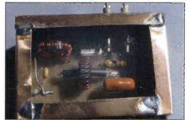
Vous reconnaissez ici le traditionnel capteur d'ondes réfléchies et directes d'un rosmètre à double aiguilles.
