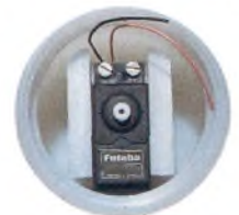
Le servomoteur assure l'ajustement de l'inductance.
