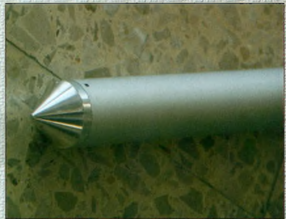
Le pied du mât télescopique Maldol en forme de pointe, voir les actues.
