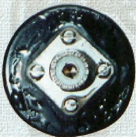
▶ Le BALUN ITA modifié pour son usage avec l'antenne demi-onde.
