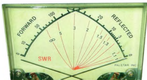
▲ Le cadran d'affichage d'un ros- mètre-watt- mètre à aiguilles croisées
