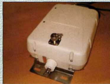
Modification de la connectique partie haute.
