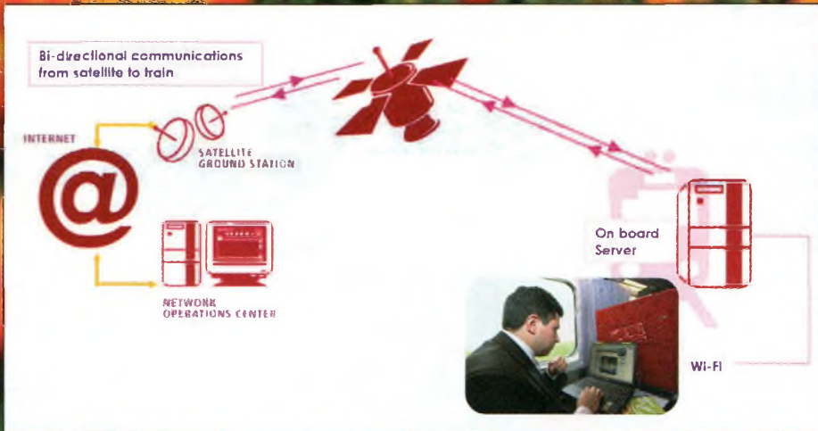
Ci-dessus : la radôme cachant l'antenne satellite par où passeront toutes vos liaisons Internet depuis le train Thalys. Ci-contre : synoptique du fonctionnement du système proposé par 21Net.
