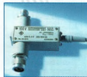
▲ Fig.42 : Tête de mesure à insertion de 100V URV524 avec diviseur tubulaire pour mesures de tensions coaxiales dans la gamme de fréquences de 0.1 à 2000 MHz. Photo 40621/1.
