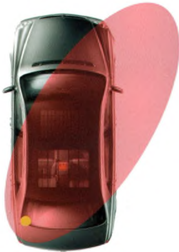
A l'arrière gauche, le lobe se dirige vers l'avant droit du véhicule.
