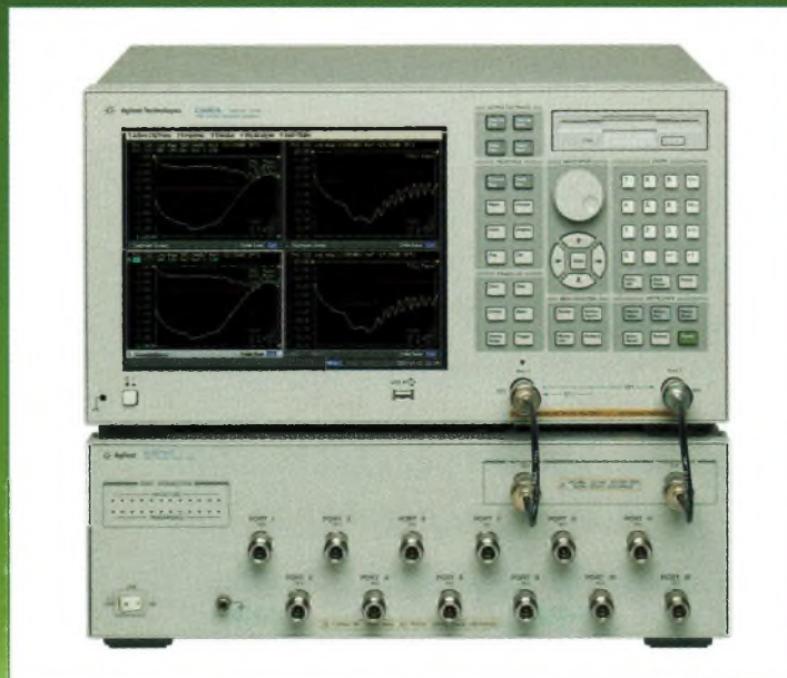
L'analyseur de réseau E5062B accompagné de son option 87075C.
