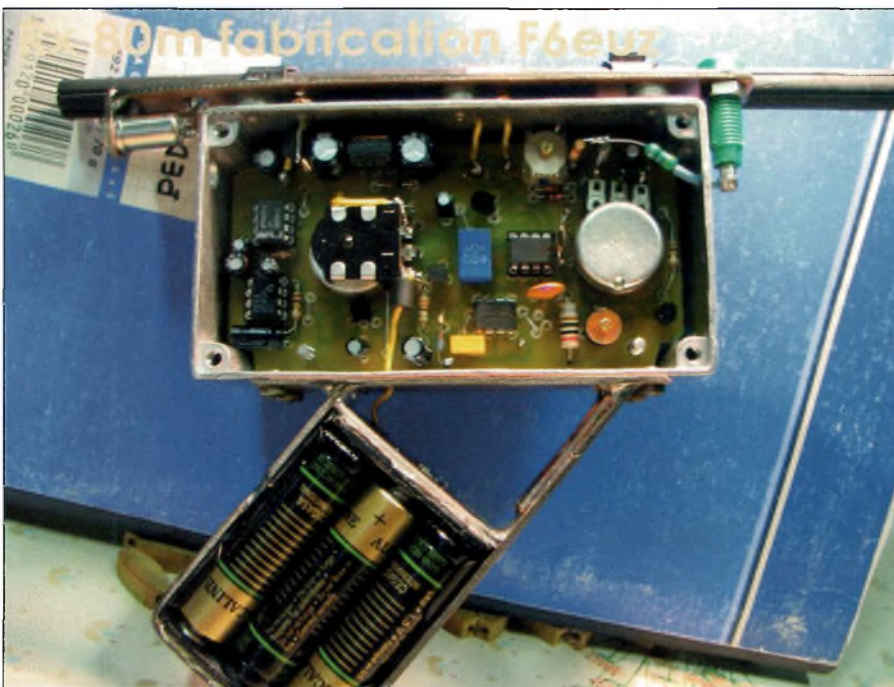
Ce récepteur 80 mètres, œuvre de Robert Ramseyer, F6EUZ, est la preuve que la conception et la fabrication de matériel ont leur place en radio-orientation. Schéma et conseils à disposition à l'ARDF-France.
