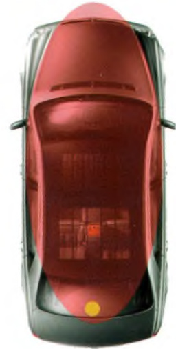
Installée à l'arrière, l'antenne produit un diagramme vers l'avant.
