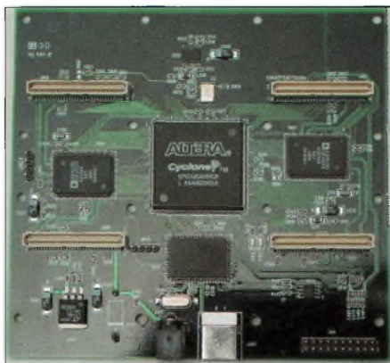
La carte d'acquisition USRP de Gnuradio. Le gros composant du milieu est la FPGA (source GNURADIO)
