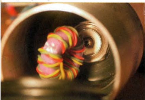
Un boîtier gris de raccord électrique fait aussi l'affaire pour protéger l'unun.
