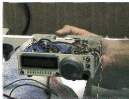
ON4XMJ a réalisé ce "Forty", émetteur-récepteur fonctionnant dans la bande 40 mètres.
