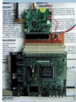
A gauche, l'une des cartes du projet HPSDR. Il numérise directement au plus près de l'antenne par des convertisseurs A/D et D/A.
