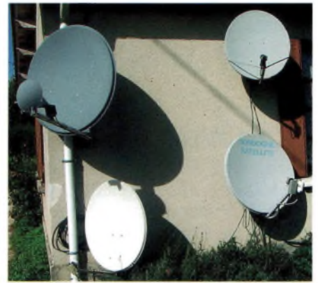
Ci dessus : Parabole grégorienne pour la réception Ku (bande 11-12 GHz) avec paraboles offset simple LNB (en bas) et double têtes à droite
