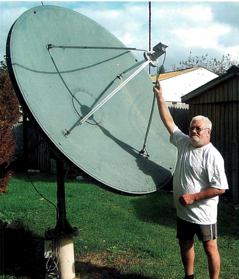
Ci dessus : Parabole grégorienne pour la réception Ku (bande 11-12 GHz) avec paraboles offset simple LNB (en bas) et double têtes à droite
