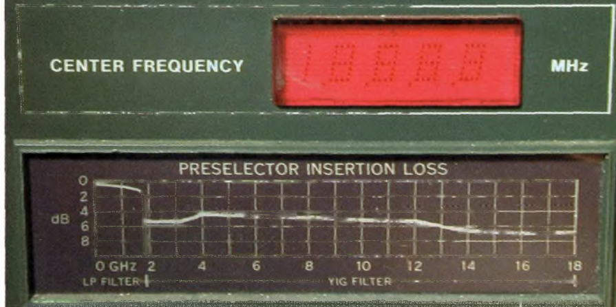
En haut, une autre station de mesures qui comporte en plus le compteur 10 Hz-18GHz HP5445A, très rare. Juste en dessous les gros plans sur l'affichage digital du HP8445A et la courbe de perte d'insertion, à prendre en compte lors d'une mesure.
