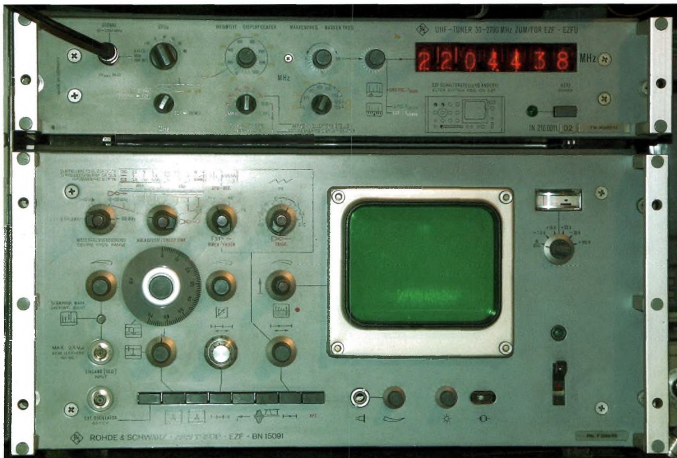
L'Analyskop de Rohde et Schwarz, analyseur de spectre très rare couvrant de 6 kHz à 2700 MHz. Il autorise des mesures et de la surveillance de spectre et offre la démodulation des signaux AM et FM. Assez simple d'emploi il se caractérise surtout par des modes de sélection automatiques contrairement aux séries HP qui demandent à l'utilisateur de faire le bon choix entre la vitesse du balayage, le span et la largeur de bande, ici, tout est pré réglé. Lui aussi a eu une sortie FI de rajoutée, voir plus loin pour les 141T.
