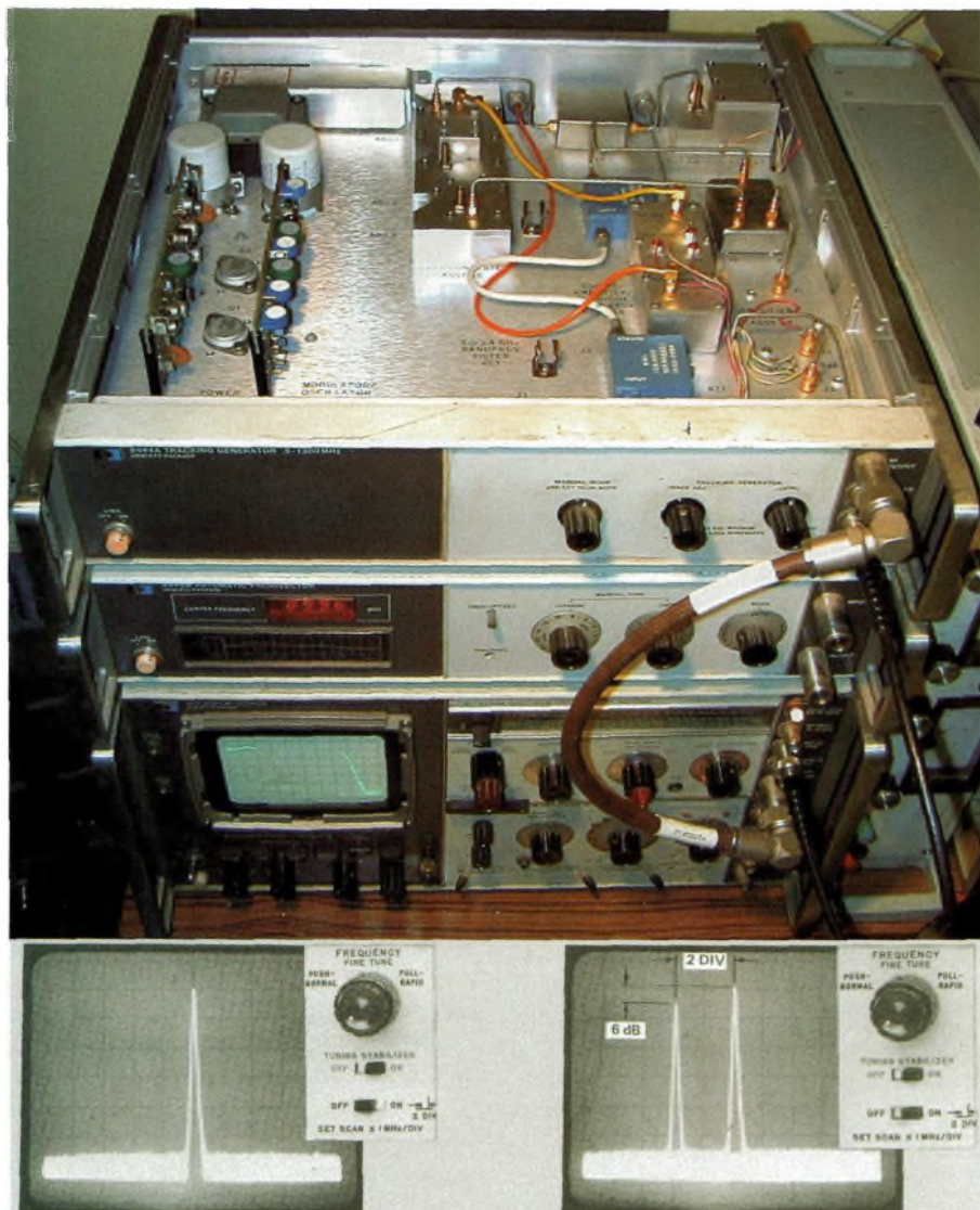
En haut, une image d'un analyseur HP141T avec tiroir 8555A, du présélecteur 8445A et du générateur de poursuite (tracking) 8444A, ouvert pour l'occasion afin de voir comment étaient réalisés les matériels RF et Hyper. Il s'agit de modules blindés reliés les uns aux autres par des câbles. L'électronique y est ajustée parfaitement et chaque sous-ensemble peut disposer de diverses options. En bas, le fonctionnement du "signal ident" lorsque l'on ne dispose pas du présélecteur 8445A.
