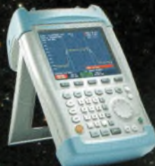
Analyseur de spectre portatif 100 KHz à 3 GHz ou 6 GHz
