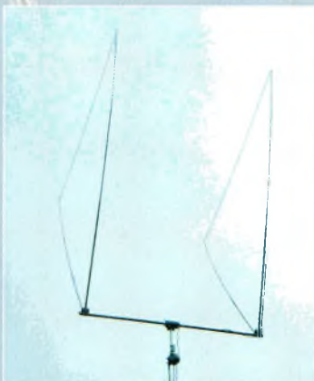
Ci-dessus et ci-contre, des exemples d'antennes delta-loop directives, respectivement de trois et deux éléments, taillées pour le 28 MHz.
