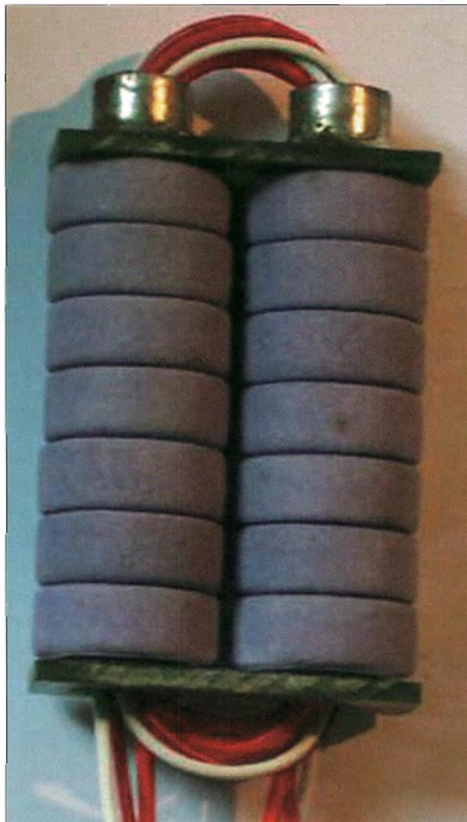
**Montage d'un balun coaxial à base de plusieurs tores empilés, simulant une ferrite binoculaire. Quatorze tores de ferrite ont été mis en œuvre dans ce montage à base de tubes de laiton.**
