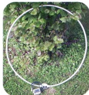
Juste avant de mettre sous presse nous recevons l'antenne boucle active ALA1530. Trop tard
