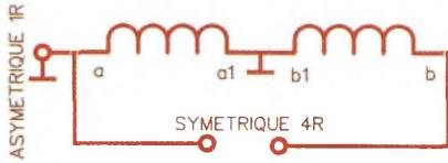
**Transformateur 1/4.** Notez que les points *a* et *b* sont les DÉPARTS du bobinage. Ce transformateur est réalisé à l'aide de 10 spires isolées de fil de cuivre ou isolées téflon (idéal) torronnées entre-elles comme on peut le voir sur nos photographies. De 50 à 200 ohms, il vous servira pour adapter vos antennes Delta-Loop, qu'elles soient alimentées à la pointe du triangle ou au centre d'un des côtés.
