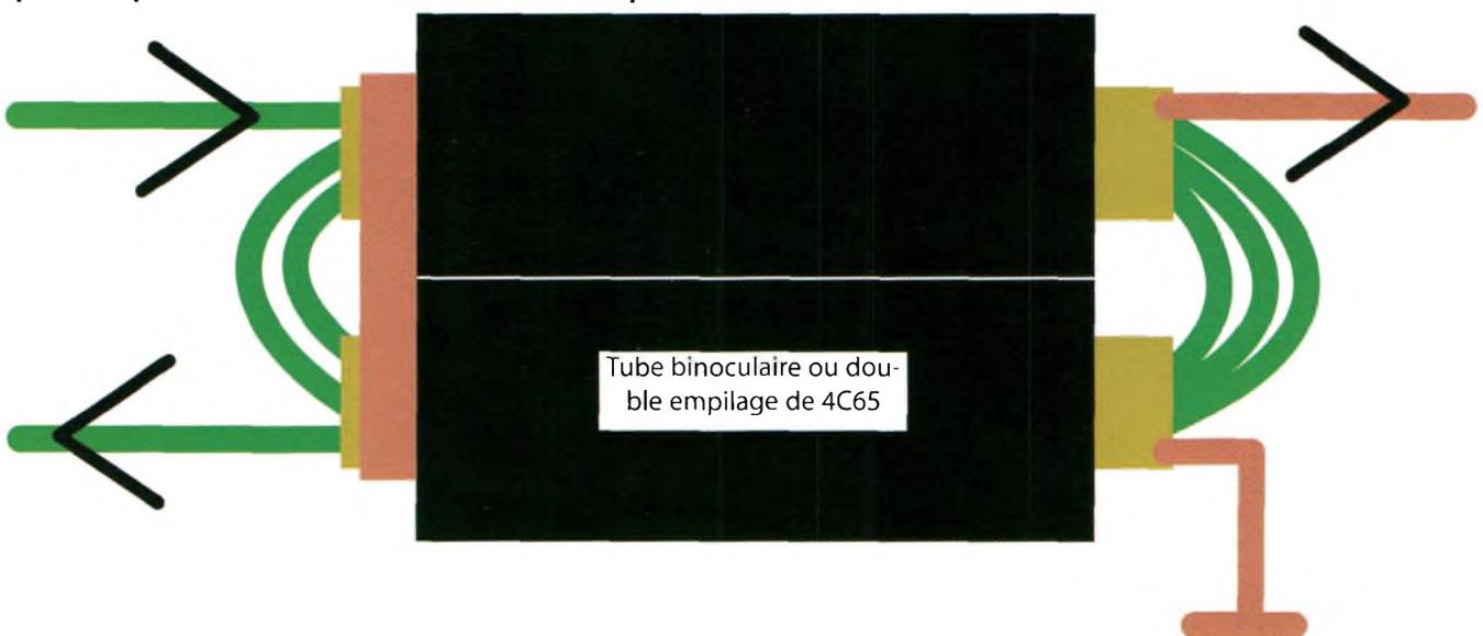
Version coaxiale du symétriseur. Deux tubes de laiton sont insérés dans deux tubes de ferrite (ou un empilage de tores). A gauche, les tubes sont reliés électriquement au moyen d'un feuilard de laiton ou d'un morceau de circuit imprimé. A eux seuls, ces tubes constituent déjà une spire. A droite du schéma, on note qu'il s'agit de la partie asymétrique, donc allant vers la station. Ces transformateurs font l'objet de la deuxième partie de cet article.
