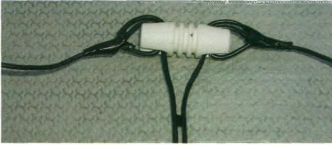
Connecter le côté opposé de la ligne à fils parallèles. N'importe quel type de connexion est possible à condition qu'elle soit stable et correctement fixée (un « domino » peut-être mis, mais que pour les essais).
