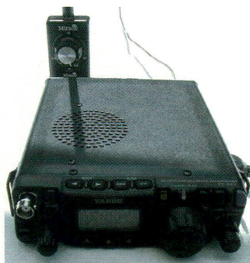
Toutes les bandes vers la PL et en avant, le gros bouton de cette antenne sert à trouver un accord sur la fréquence de travail.
