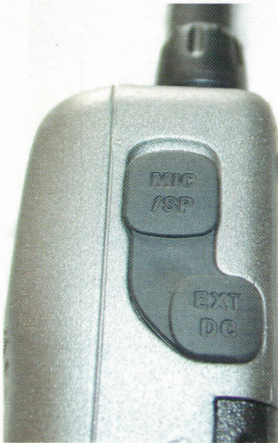
Les prises d'alimentation extérieure et le connecteur commun au HP et au microphone prennent place sur le côté gauche.
