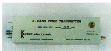
Si l'ATV vous démange sur 10 GHz, il ne reste plus qu'à monter ce module sur une parabole.
