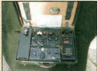
Valise A MK III dit "B2", Émetteur / Récepteur de fabrication Anglaise de 1941, Fréquences de 3 à 16 MHz, puissance 20 Watts CW, 420x273x123mm, poids 14,8 KG, Alimentation tout secteur.
