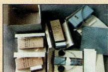
MCR 1 dit biscuit, récepteur de 0,15 à 15 MHz en 4 bandes, Poids 0,91Kg, 89x51x216mm, Alimentation par batterie.
