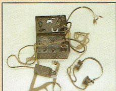
MK 128, Émetteur / Récepteur anglais de 2 à 8 MHz, Puissance 1 Watt en CW, Alimentation batterie poids 5,9Kg, 305x432x165mm
