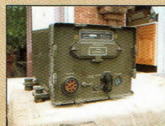
DY-88 : le générateur des hautes tensions nécessaires au BC-1306.
