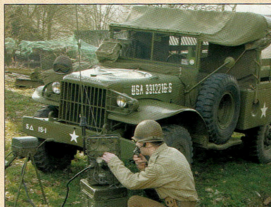
Le BC-1306 en cours d'opération aussi connu sous le nom SCR694 dont les déclinaisons deviendront des AN/GRC9 sur lesquels nous reviendrons. La génératrice à pédale GN-58 et un BC-611 aussi appelé SCR-536 sur lequel nous reviendrons également.
