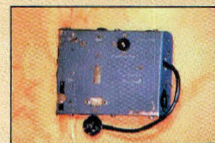
53 MK I, Récepteur de 3 à 10 MHz, poids 0,80Kg, Dimensions 102x89x32mm, Alimentation 102x76x32mm
