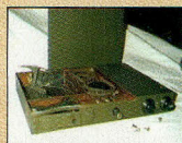
Le récepteur livre, homologue du "biscuit" utilisé par les services américains de renseignement en France le SC666 (le couvercle se détache pour un accès au casque et à l'antenne).
