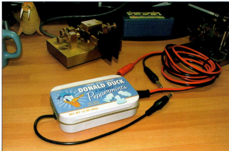
Montage du cordon à la mode "F6IIE" avec un fusible sur chaque fil et tore de ferrite de filtrage.
