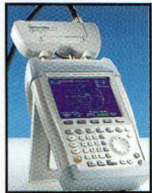
Fig.19 : Wattmètre thermique NRS pour mesure du continu à 15 GHz.
