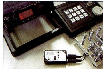
Une vue de l'ensemble complet avec keyer, clavier de télécommande et support d'inclinaison. On reconnaît sur la droite une des clés du fabricant Japonais GHD, de type iambique.
