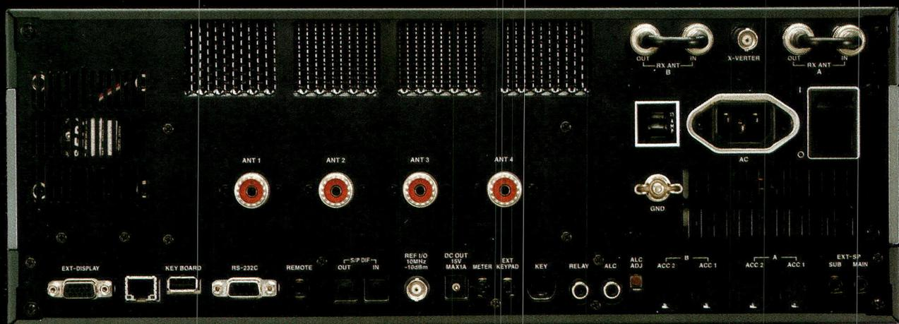
Les quatre connecteurs d'antennes sont bien visibles et amplement espacés derrière le transceiver.
