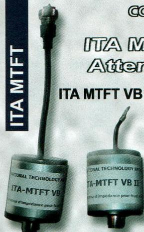
**ITA MTFT VB II** ITA MTFT : Abaisseur d'impédance de rapport 1:9 bobiné sur véritable torre de ferrite HF pour construire des antennes "long fil", peu onéreuses et destinées à un usage ponctuel : week-end, vacances, etc. Puissance max. : 300 W PEP. Utilisation avec boîte de couplage recommandée selon la longueur du fil (minimum 5,5 m).
