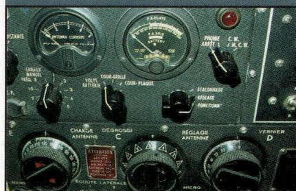
Je l'utilise quant à moi couplé à un récepteur AME 7G 1680 MA avec le N°1380. Bien que l'ART-13 possède un relais d'antenne sous vide, une des difficultés rencontrées lors de la mise en œuvre de l'ensemble a résidé dans la mise en stand by du récepteur lors du passage en émission.
