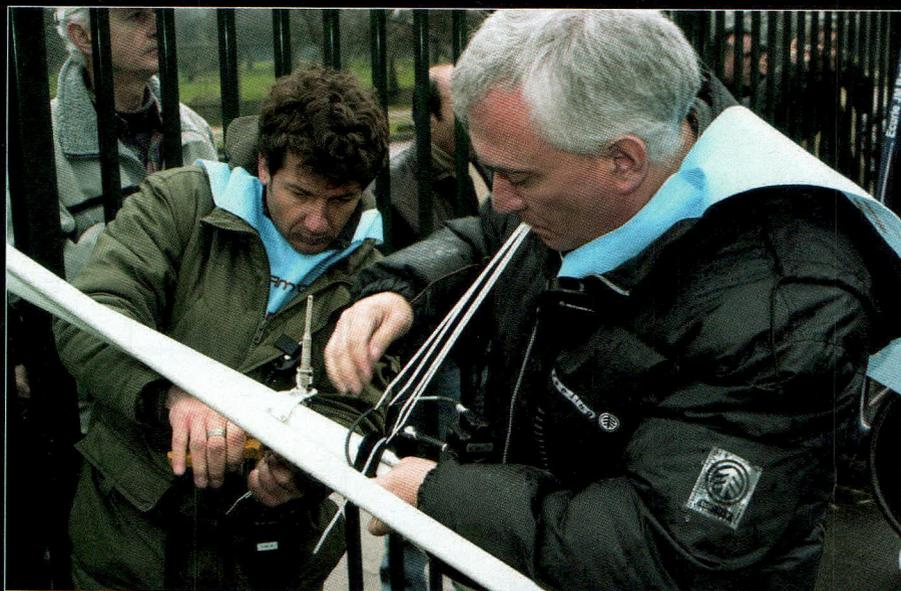
Installation de l'antenne 2,5 GHz sur le brancard droit du sulky.
