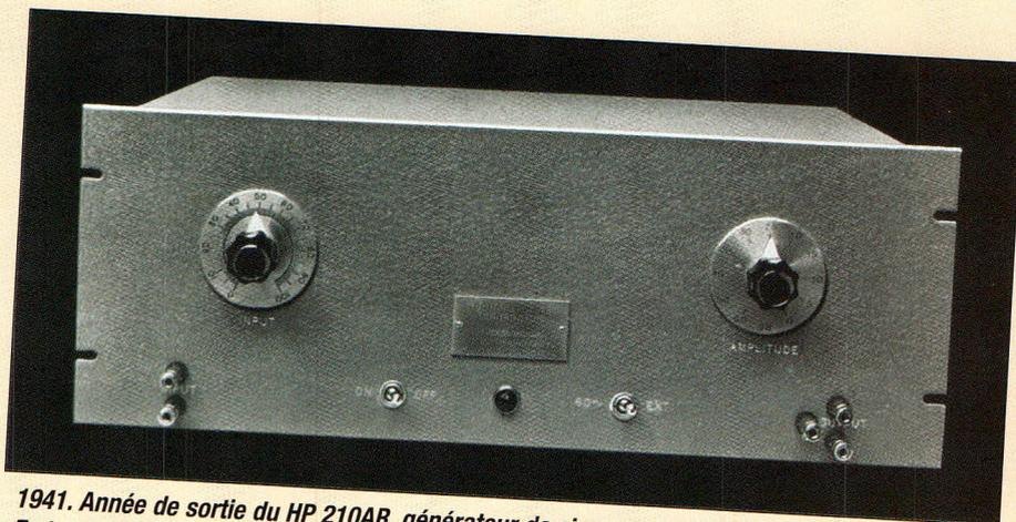
1941. Année de sortie du HP 210AR, générateur de signaux carrés. (Photo Agilent Technologies)
