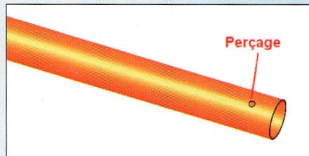
Sur le tube de 32 mm de diamètre, vous percerez un trou de 3 mm de diamètre, à environ 1 cm d'une extrémité. Vous procéderez de même sur le tube de 10 mm de diamètre (long de 1 m). Précisons que le perçage doit se faire au travers des deux surfaces.
