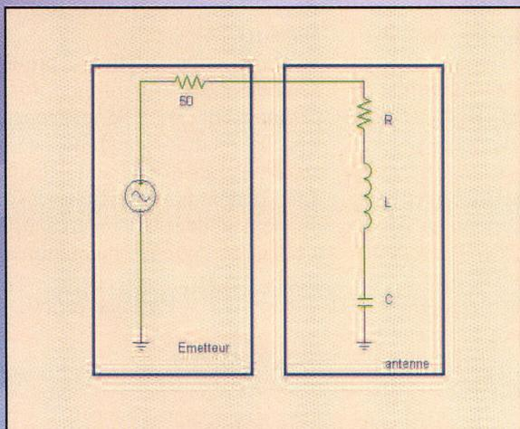
Pour avoir un transfert optimal de puissance, il faut que l'impédance de l'émetteur soit égale à l'impédance du récepteur (ici, l'antenne). Nous avons vu précédemment que l'impédance était fonction de la fréquence et on comprends mieux pourquoi une antenne ne peut fonctionner de façon idéale que sur la fréquence pour laquelle il a été prévu qu'elle travaille (il existe des antennes multi bandes, mais cela sort du cadre de cet article).
