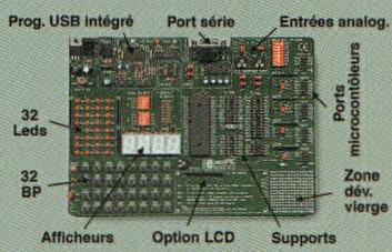
Starter-kit pour développement sur microcontrôleurs PIC™ - Programmeur USB intégré, supports pour PIC 8, 14, 20, 28 et 40 broches, livré avec PIC16F877 et nombreux exemples en assembleur, Basic, Pascal, "C".
