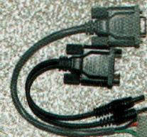
**Y-OTT** Interface pour le Z-100 ou AT-100PRO pour alimenter le tuner et communiquer avec votre transceiver Yaesu FT100, FT817, FT857 et 897... (avec le FT817, il faut alimenter le Z-100 avec une source 12 volts externe).
