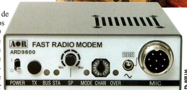
*L'ARD9800 est équipé d'un HP interne. Il est livré avec son micro. On passe de l'analogique au numérique par le simple basculement d'un inverseur en façade. Il utilise le protocole ouvert de G4GUO pour la gestion du DSP.*
