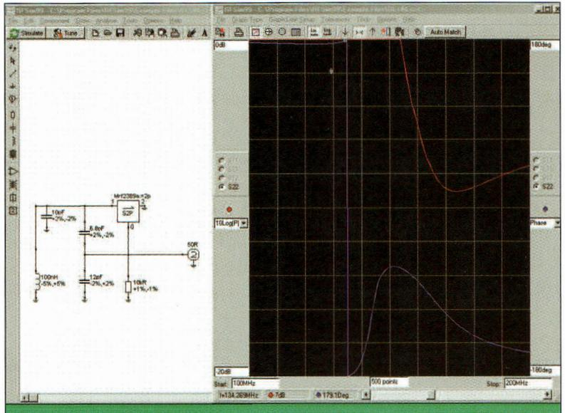
Fig. 5— Etude et simulation de l'oscillateur local.
