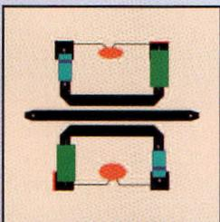
Sur le schéma d'implantation ci-contre, on notera que le repère rouge signifie que la pastille est en liaison avec le verso du circuit imprimé, donc le plan de masse. Lorsqu'on soude les différents composants, il convient de ne pas
