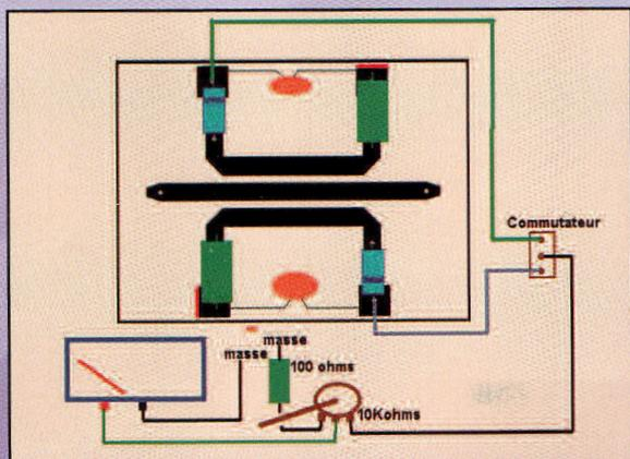
Il faudra ne pas se tromper au moment du soudage des fils sur le galvanomètre, car ce dernier est polarisé. Si vous inversez les fils, l'aiguille, en présence d'une tension aux bornes du galvanomètre, aura tendance à aller vers la gauche, ce qui lui sera d'ailleurs difficile...
