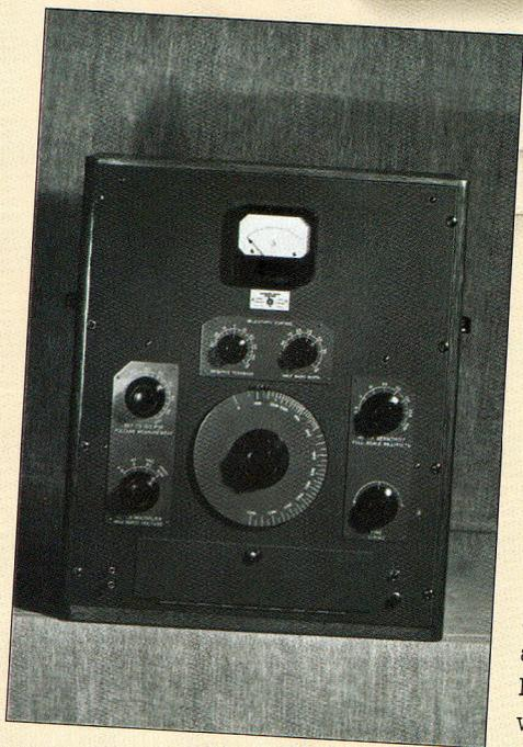
Le HP 300A, sortie en 1941, était un analyseur d'harmoniques plutôt complet. (Photo Agilent Technologies)
