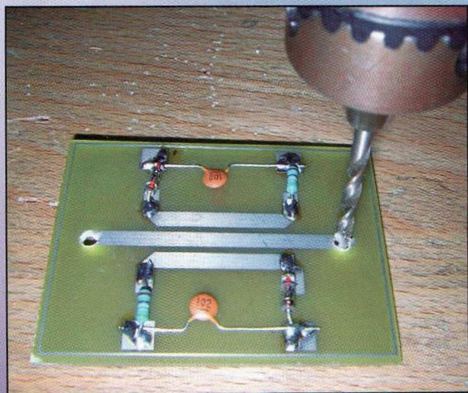
▲ Ne pas oublier de percer le circuit imprimé afin de pouvoir, par la suite, souder les prises BNC.
