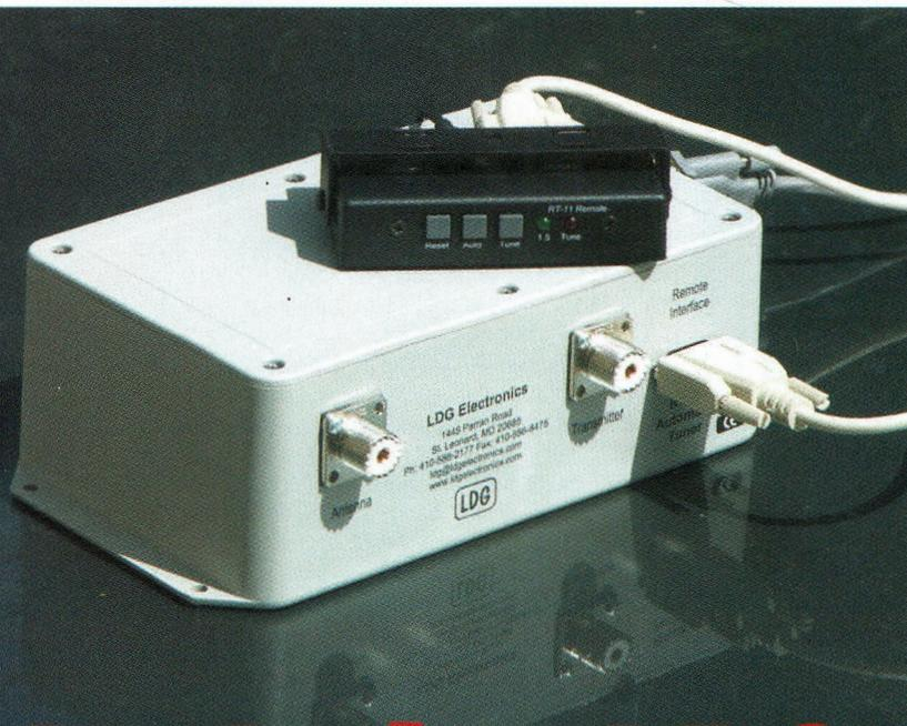
Nous n'allons pas revenir dans cet article spécifiquement sur la boîte d'accord RT-11 mais plutôt vous parler de son extension fort utile, le "remote unit". Dans sa livrée d'origine, la RT-11 fonctionne déjà au plus près de l'antenne jusqu'à une distance de 33/35 mètres de la station. Le simple fait d'appuyer sur le bouton "tune" de votre transceiver lance la recherche du meilleur accord possible en un temps record.
