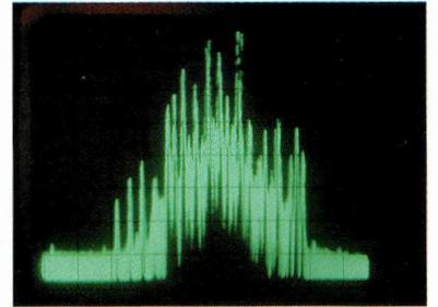
L'AR8600 MARK II propulse à 3 GHz un analyseur de spectre 100 MHz comme HP8553B.
