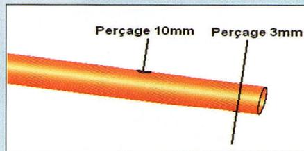
Nous allons procéder à un second perçage dans le tube de 32 mm. Ce trou sera d'un diamètre de 10 mm et sera placé à 10 cm de la base du tube, comme indiqué sur le croquis ci-dessous. Cette fois-ci, il convient de percer simplement une surface, et non les deux.
