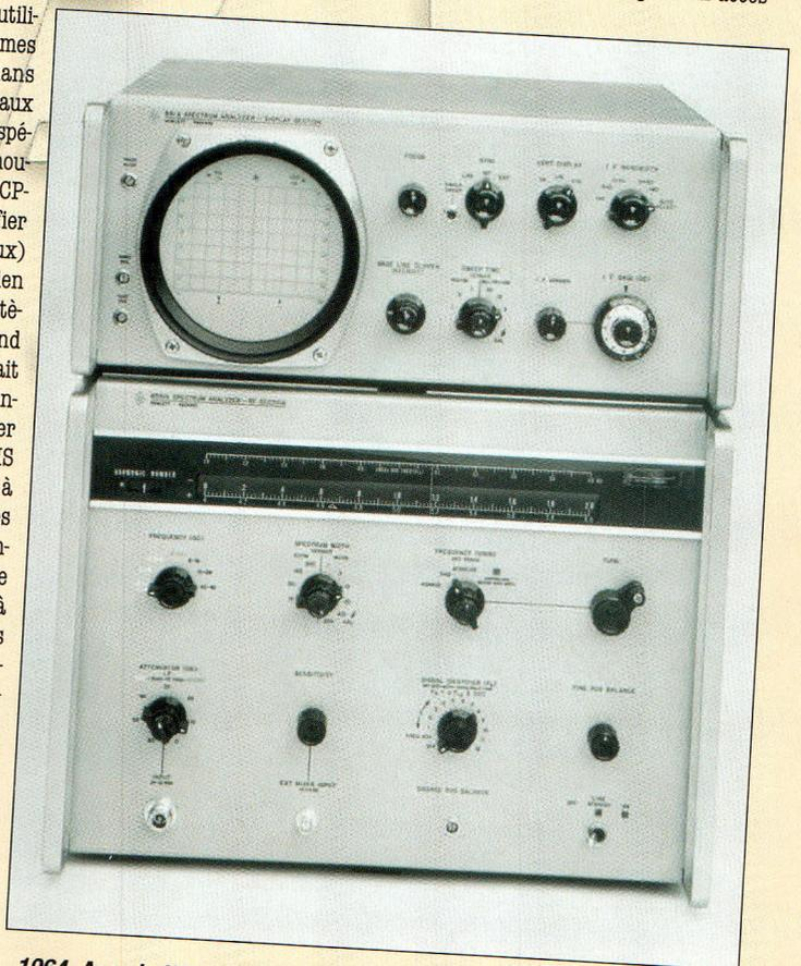
**1964.** Avec le HP 8551A, Hewlett-Packard entre de plein fouet dans le marché des analyseurs de spectre. Ce produit proposait un nombre significatif de fonctions par rapport aux appareils concurrents.
