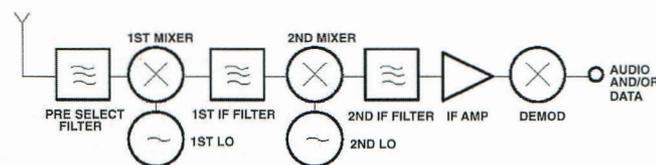
Fig. 3— Le synoptique d'un récepteur à double changement de fréquence.
