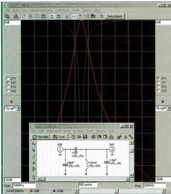
Fig. 4— Etude et simulation de l'étage d'entrée du NE602.
