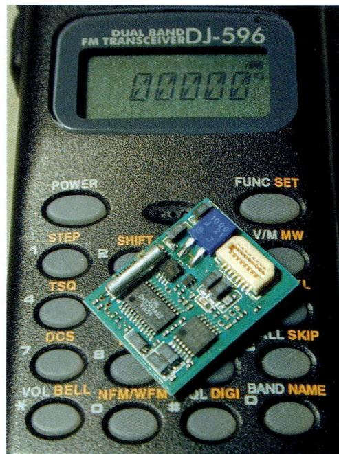
A l'arrière de l'appareil, sous les accus, se trouve une trappe, sous celle-ci apparaît un logement pour y insérer la carte EJ43U, vue ci-dessus.
