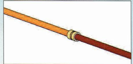
antenne sans qu'elle ne prenne trop de place. Il convient simplement de placer le manchon femelle/femelle sur le tube de cuivre de 10 mm, et le tour sera joué. Il est possible que ce manchon s'insère en forçant légèrement, mais cela ne constitue en rien une gêne, bien au contraire : cela confère une solidité à l'antenne.
