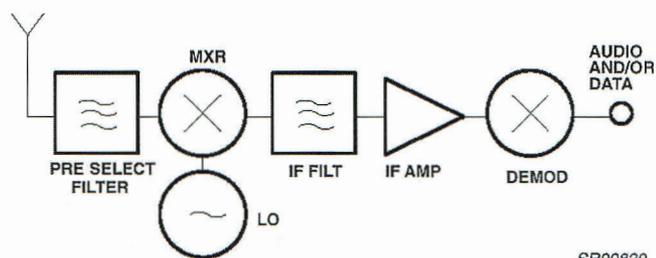
Fig. 2— Le synoptique d'un récepteur à simple changement de fréquence.
