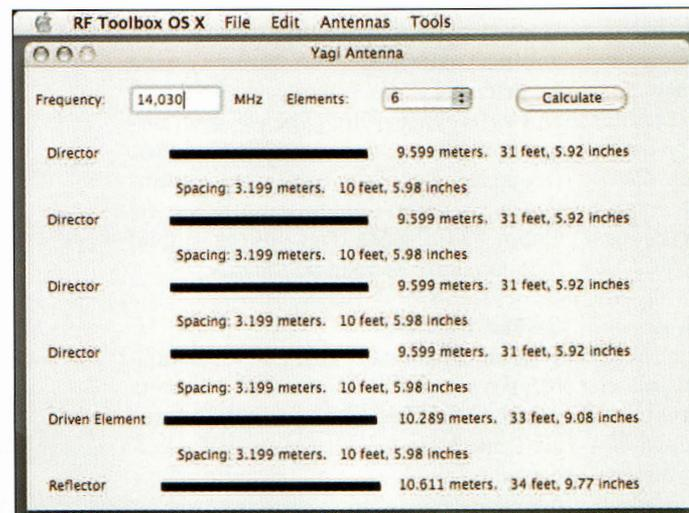
**Rapide aperçu des dimensions d'une antenne Yagi à 6 éléments taillée pour la fréquence 14,030 MHz.**
