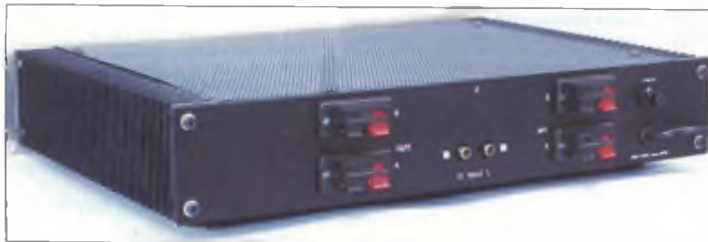
Figura 2. Aspetto esterno dell'amplificatore montato. Tutti i condensatori elettrolitici dovranno essere montati isolati rispetto al mobiletto. Attenzione però: tra gli involucri positivi e negativi dei condensatori è presente una tensione di 60 V, perciò sono indispensabili i piedini di gomma.
