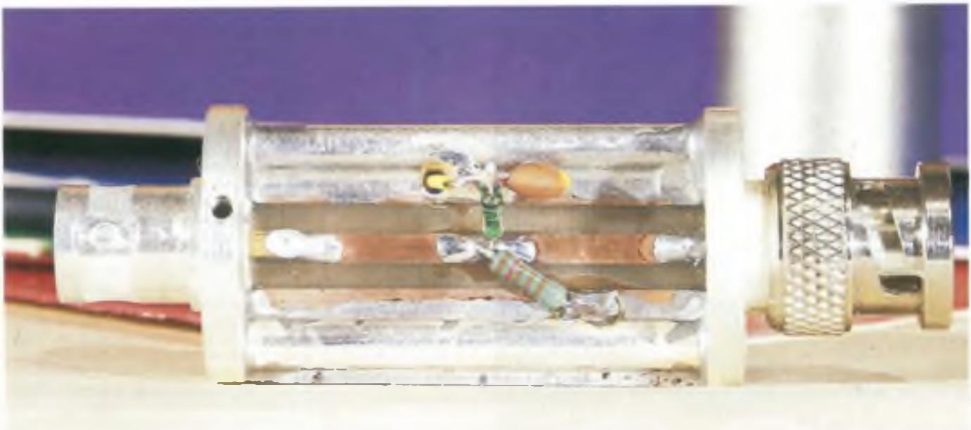
**Figura 12.** Sulla basetta della stripline è praticato un foro per il filo di collegamento e si vede anche il relativo condensatore di disaccoppiamento. Attenzione ad effettuare saldature "pulite". Il conduttore interno della stripline non deve essere più largo di quello indicato!
