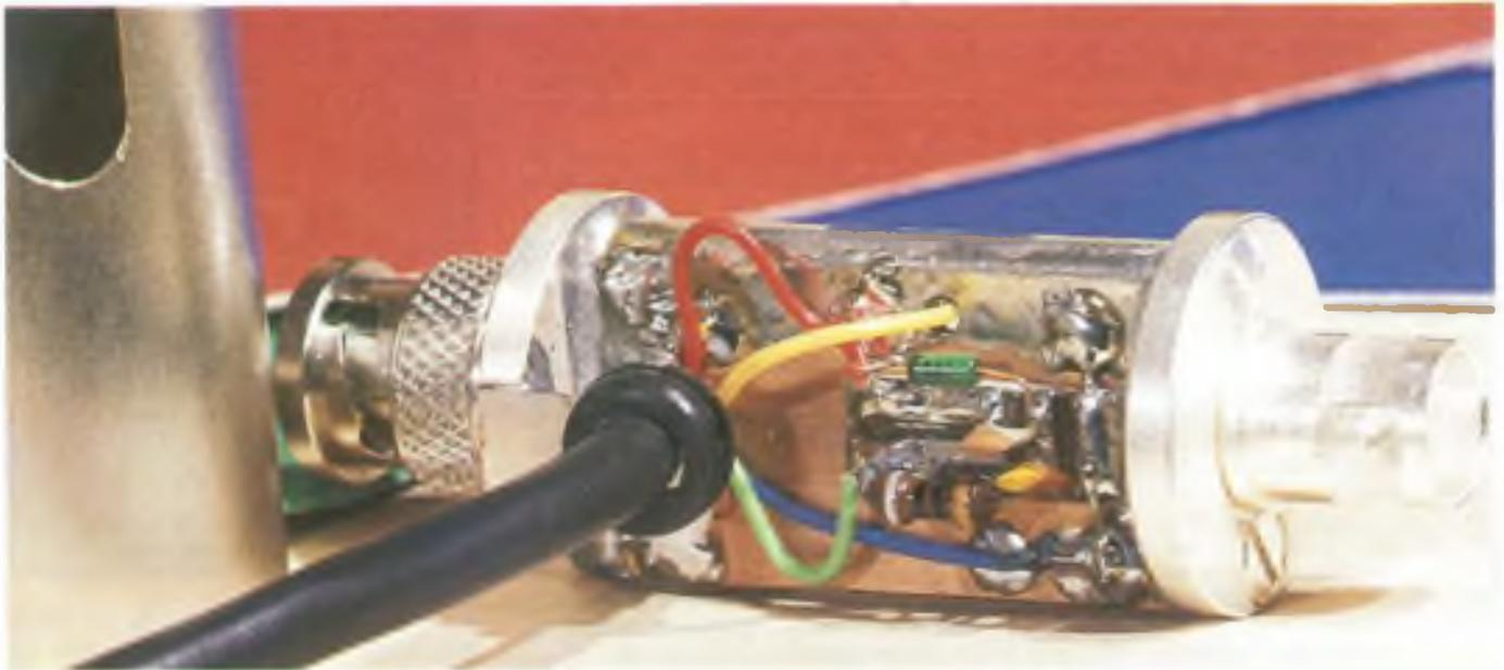
**Figura 11.** Adattatore da laboratorio completamente montato. La basetta dei rettificatori è montata sul "dorso" (piano di massa) della basetta a stripline
