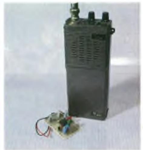
**S**u tutti gli apparati amatoriali V/UHF FM dell'ultima generazione, compresi i portatili tipo Walkie Talkie, è presente un oscillatore a 1750 Hz utilizzato per trasmettere una nota a questa frequenza. Tale dispositivo viene normalmente impiegato per attivare un ponte ripetitore.
