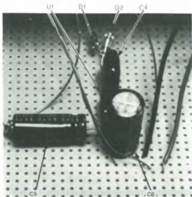
Foto 4. I componenti montati sulla basetta perforata sono disposti come indicato sullo schema. Disporre i componenti d'ingresso e di uscita alle estremità opposte dell'amplificatore a circuito integrato U1, per evitare effetti di reazione.
