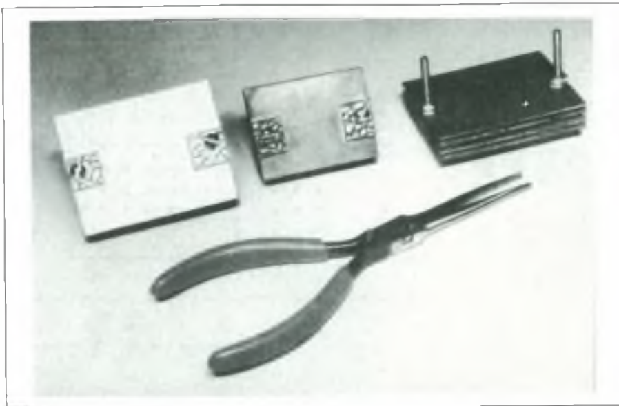
Foto 1. I condensatori sono facili da costruire: ritagliarli con un seghetto, smussare gli angoli con una lima, una carta vetrata ed una smerigliatrice orbitale, praticare i fori sovrapponendo le lastrine e poi assemblare le sezioni mediante viti.
