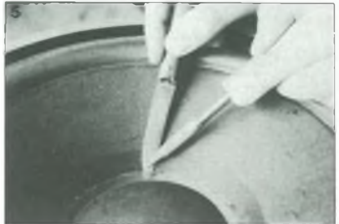
Figura 5. Smontaggio della calotta antipolvere del cono dell'unità di eccitazione per i toni bassi.
