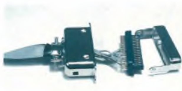
Figura 7. Particolare del connettore per la stampante. Data la vicinanza dei piedini, usare con molta cautela il saldatore, utilizzando stagno fine e di buona qualità.
