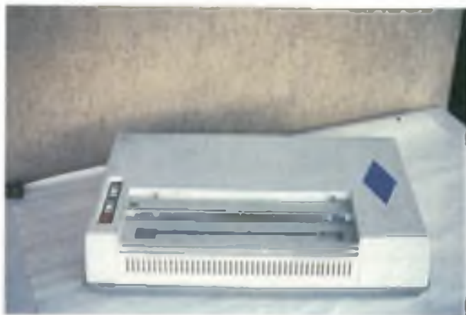
Foto 1. Apparato facsimile telefonico Rank Xerox RX400; questa apparecchiatura si presta molto bene ad essere modificata per il funzionamento via radio.
