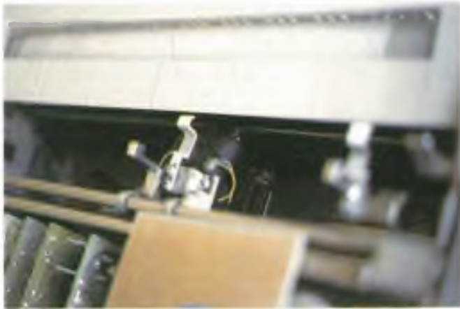
Foto 2. Particolare di un gruppo di scansione di un fax convenzionale: si notano tanto l'ottica di scansione (cilindretto nero rivolto verso il tamburo), quanto il pennino di scrittura (subito sotto).
