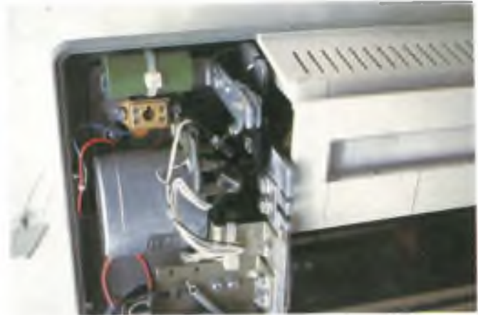
Foto 3. Sensore di posizione del tamburo. In questa macchina si tratta di un dispositivo ottico con due fotocelle.
