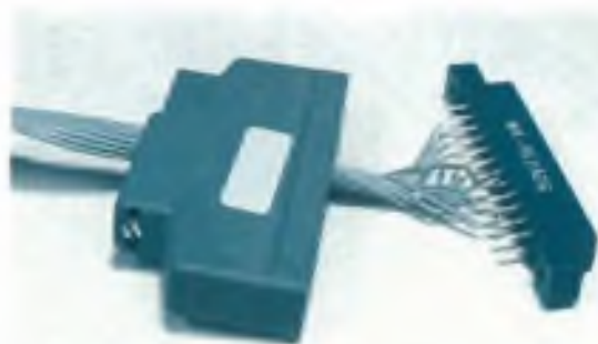
Figura 6. Particolare del connettore per la user port del C64. Si raccomanda di mettere un bollino sul lato alto della conchiglia, come vede nella foto, per evitare accidentali capovolgimenti.
