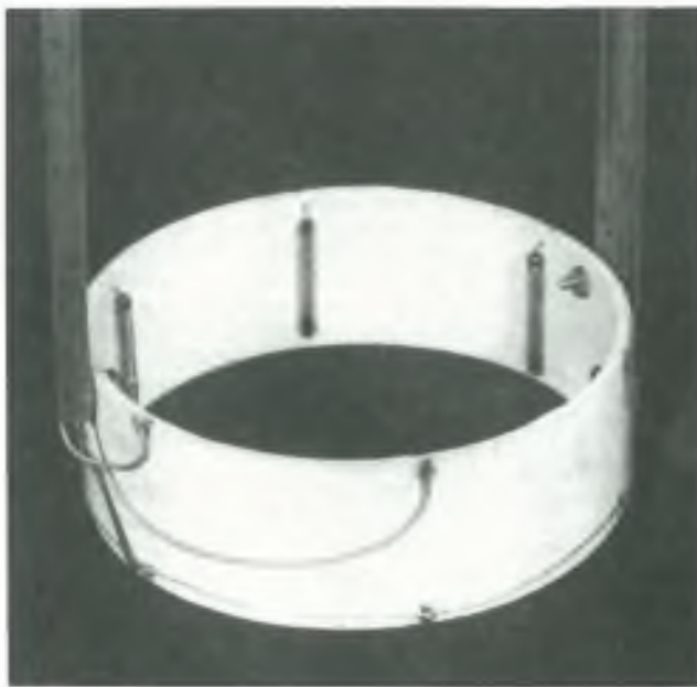
Foto 1. Piegare e saldare i terminali degli interruttori Reed prima di fissarli in posizione, nel caso uno dovesse rompersi. Montarli poi ad intervalli uguali lungo la parete interna del cilindro di plastica, in modo che non interferiscano con le viti di fissaggio.
