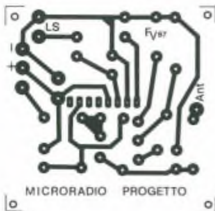
Figura 2. Il circuito stampato del ricevitore per Onde Medie e Corte in scala 1:1. Può essere realizzato indifferentemente su bakelite o su vetronite: la basetta da ritagliare, quadrata, misura 56 mm di lato.
