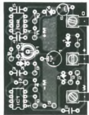
Figura 2a. Le grandi superfici ramate sul circuito stampato scala 1:1, servono a facilitare il fissaggio diretto del circuito stampato sul retro dello strumento indicatore a bobina mobile.
