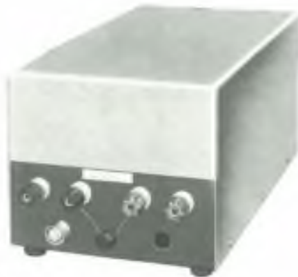
Figura 4. Vista posteriore dell'accoppiatore. Sono visibili i morsetti di collegamento ed il connettore coassiale di ingresso.
