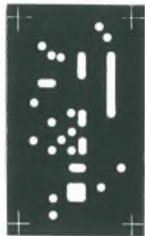
Figura 3. Il piano di massa sul lato componenti serve a mantenere brevi i collegamenti, come richiesto per le UHF.
