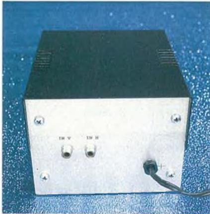
Foto 3. Sul pannello posteriore, oltre al cavo di alimentazione, sono presenti le entrate per le assi X e Y.
