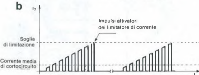
Figura 2. Funzionamento dei circuiti soft start (a) e del limitatore di corrente (b) nel chip L4960.
