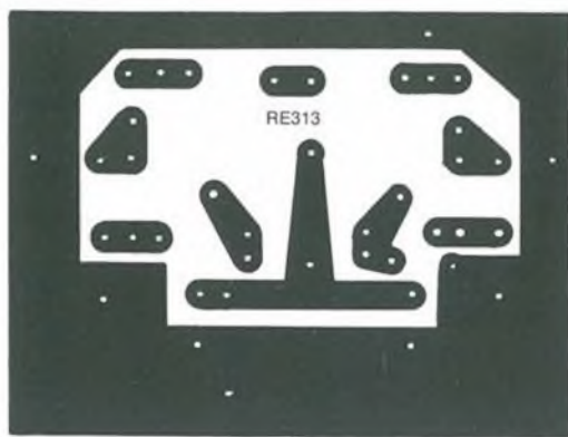
Figura 4a. Circuito stampato scala 1:1 per il montaggio dei trimmer R5-R6.
