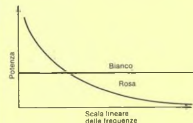
Figura 7. Curve caratteristiche potenza/frequenza del rumore bianco e del rumore rosa.
