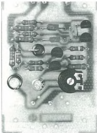
Foto 1. Il convertitore tensione/frequenza è semplicemente un multivibratore modulato in frequenza.
