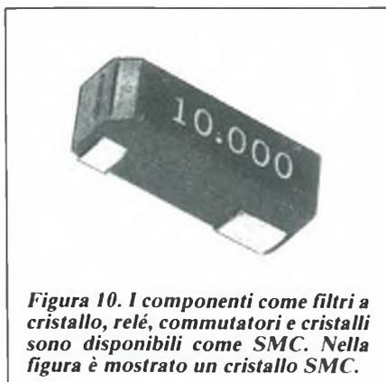
Figura 10. I componenti come filtri a cristallo, relé, commutatori e cristalli sono disponibili come SMC. Nella figura è mostrato un cristallo SMC.
