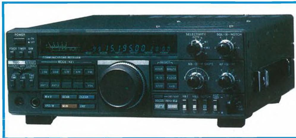
cezione in FM. Gli SWL più esigenti e gli amanti della telegrafia possono installare una coppia di filtri opzionali (1,8 kHz per la SSB e 500 o 270 Hz per il CW) per assicurare una migliore ricezione, selezionabili da un apposito commutatore.
