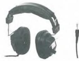
Con regolazione di volume e commutatore mono/stereo. Impedenza 8 Ohm. Potenza 2x0,3 W. Peso 350 g. Cavo spiral. 1,5 mt. (Altre cuffie pagg. 66-69 Catalogo Monacor)
