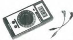
Per misure rapide di induttanze, resistenze, capacità con precisione digitale. Misure dirette di tutti i valori. Connettori rapidi studiati per evitare false misure. Capacità: 0-200 mF in 7 scale. Induttanze: 0-2 H in 5 scale. Resistenze: 0-20 MOhm in 6 scale. Display: LCD 3 1/2 DIGIT, 12 mm. Aliment. esterna o interna 9 V. Dimensioni 87x172x35. (Altri strumenti pagg. 163-185 Catalogo Monacor)
