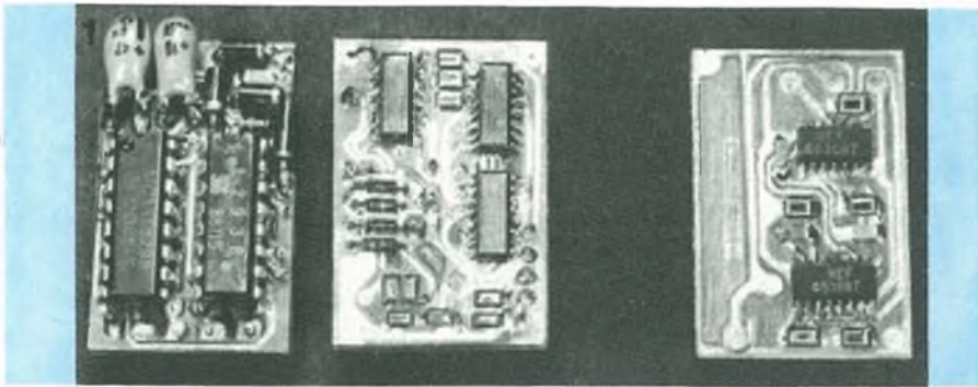
Figura 1. Vista delle due facce del decodificatore per locomotiva: normall componenti sul retro e componenti SMD sul verso. Questo sistema permette di ottenere la massima compattezza. Il circuito all'estrema destra è l'adattatore per rete e due rotaie.
