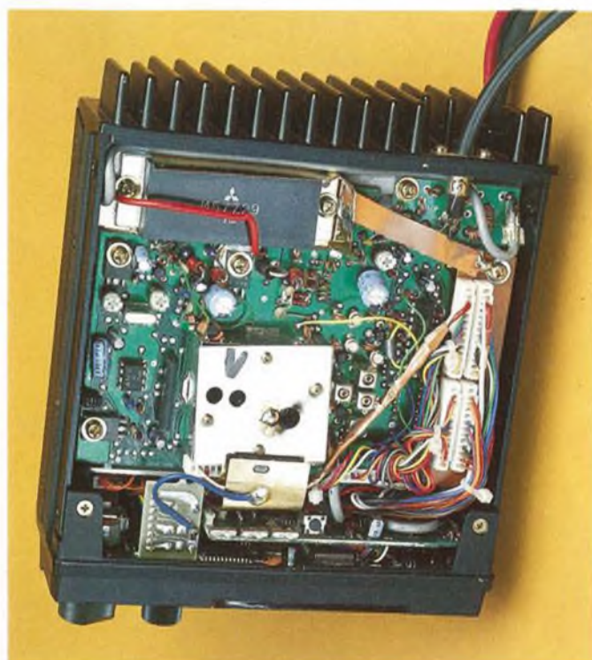
I due ricetrasmittori dell'ALD24E sono separati anche fisicamente: nelle due foto sono visibili la parte VHF (a sinistra) e quella UHF (a destra). A queste sezioni si accede aprendo i due coperchi. La CPU è alloggiata dietro alla mascherina del pannello frontale, ed è appena visibile nella foto a destra.
