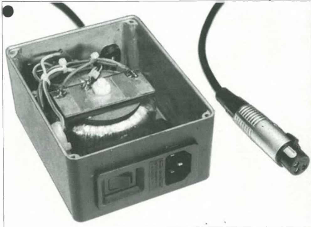
Figura 1. L'alimentatore per il PREAMP è montato in un contenitore separato.
