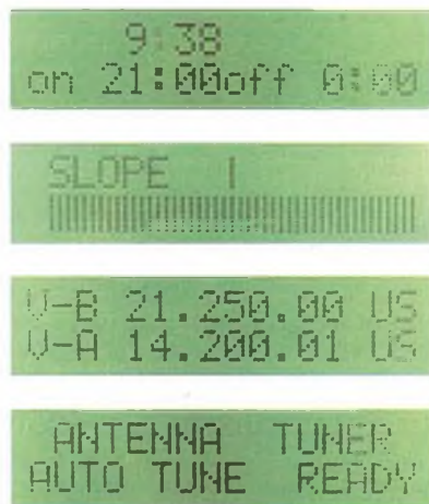
Il subdisplay LCD multifunzionale del TS-940S.
