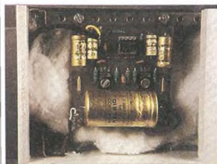
Figura 4. Circuito stampato della sezione relè scala 1:1 e disposizione dei componenti
