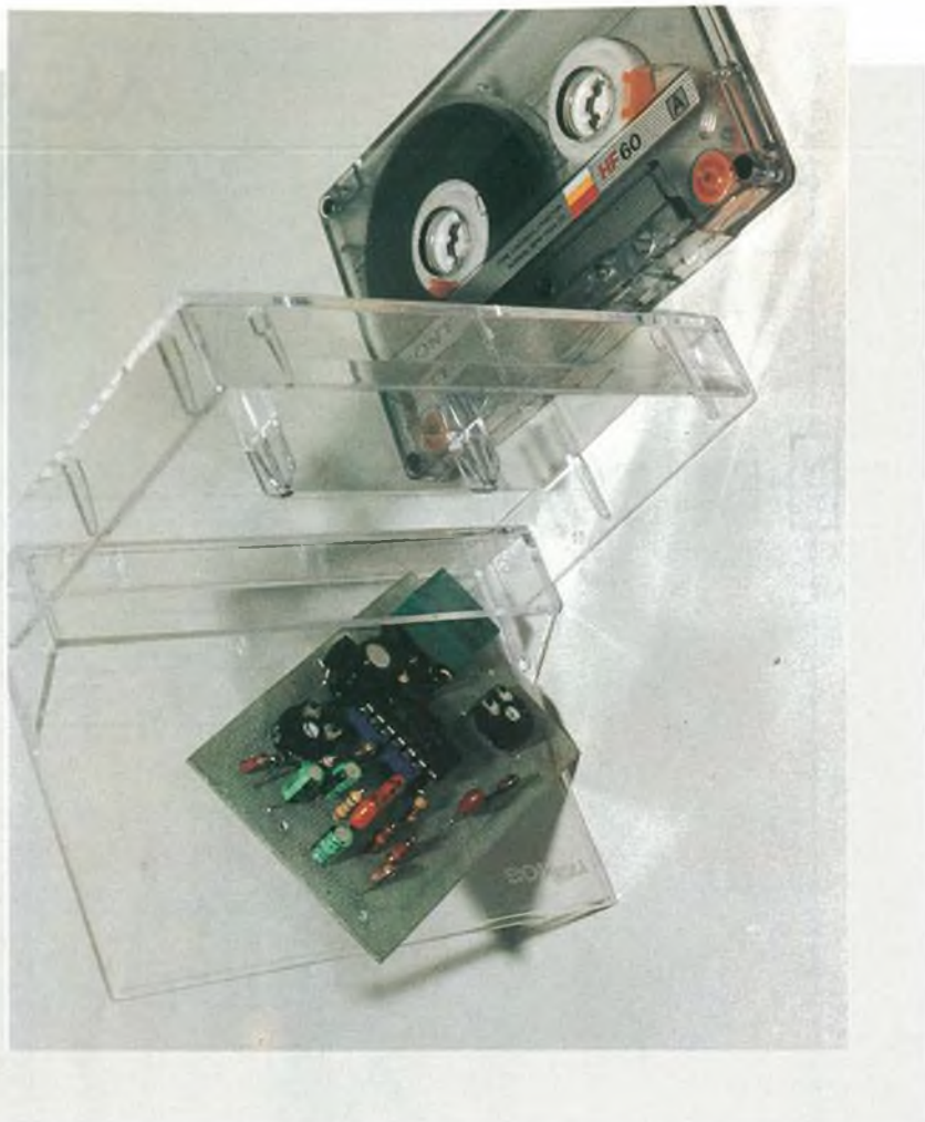
Foto 2. Le dimensioni stremamente contenute del VOX le permettono l'installazione anche all'interno di contenitori molto piccoli
