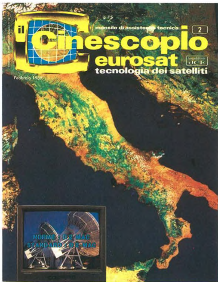
L'immagine fisica dell'Italia vista dal satellite è la risultante di una elaborazione computerizzata ottenuta da misure effettuate sulla energia riflessa dalla Terra, in sette bande spettrali, a mezzo del LANDSAT 5, in orbita circolare sincrona con il Sole, a una altezza di 705 km.
