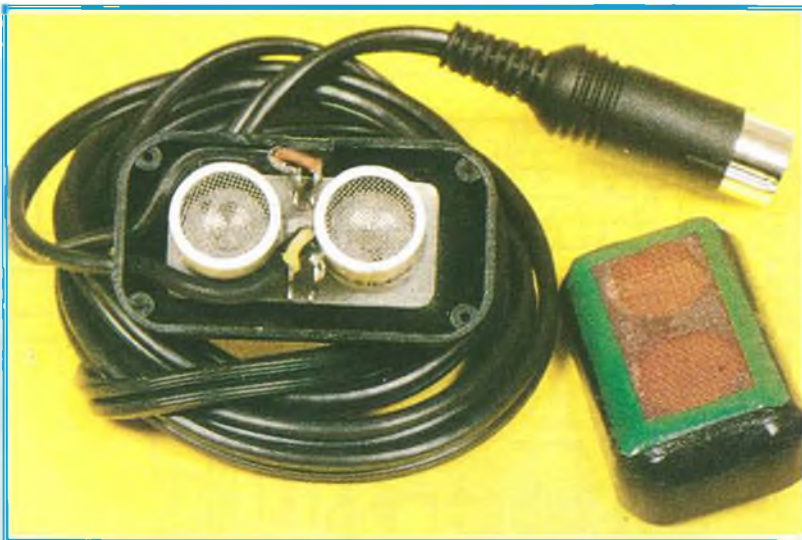
Foto 4. Aspetto esterno dei moduli trasduttori.
