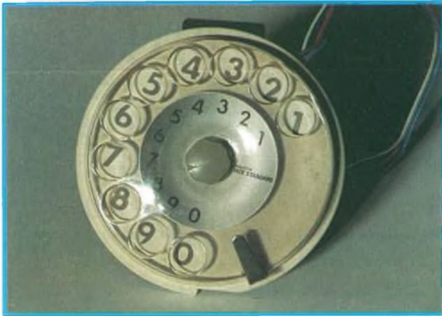
Foto 2. Il vecchio disco combinatore meccanico viene sostituito sui nuovi telefoni da una tastiera digitale.
