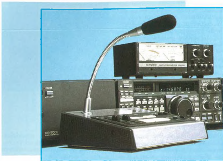
Figura 5. In una buona stazione di radioamatore non bisogna sottovalutare l'importanza che riveste il microfono; infatti una cattiva risposta in frequenza di quest'ultimo si riflette in tutti gli stadi successivi ed inficia la qualità finale dell'emissione.
