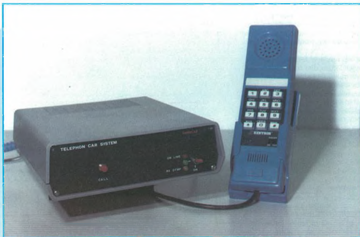
Foto 1. L'interfaccia completa è alloggiata in un elegante mobiletto che le conferisce un aspetto decisamente professionale. Qui è visibile con un apparecchio telefonico modificato, facente le funzioni di interfono.
