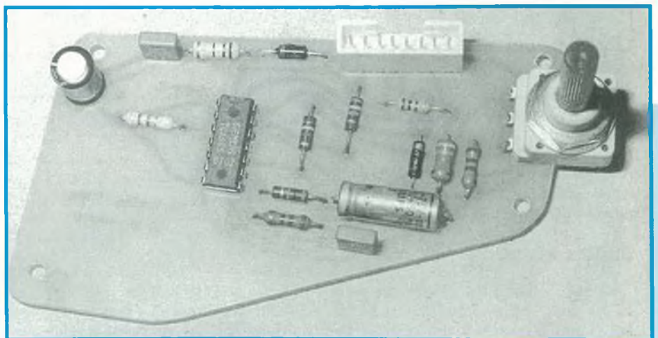
Foto 2. Prototipo del regolatore montato. La costruzione non è critica e la sagomatura della basetta dovrà essere naturalmente adattata al vano disponibile in un eventuale diverso armadio refrigerante.
