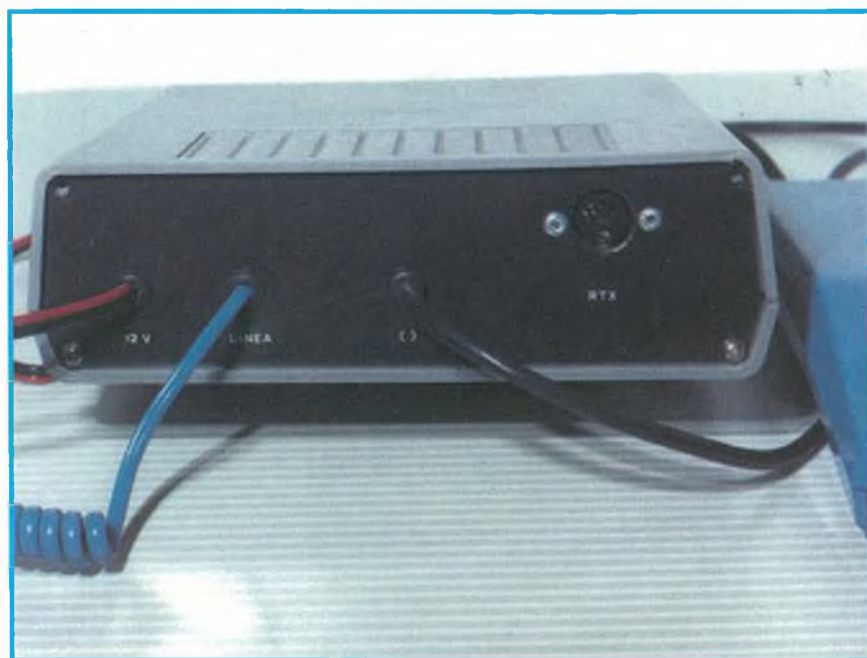
Foto 3. Vista posteriore dell'interfaccia; è visibile il connettore di collegamento all'RTX nonché i fili di collegamento all'alimentazione, alla linea telefonica e all'apparecchio telefonico.
