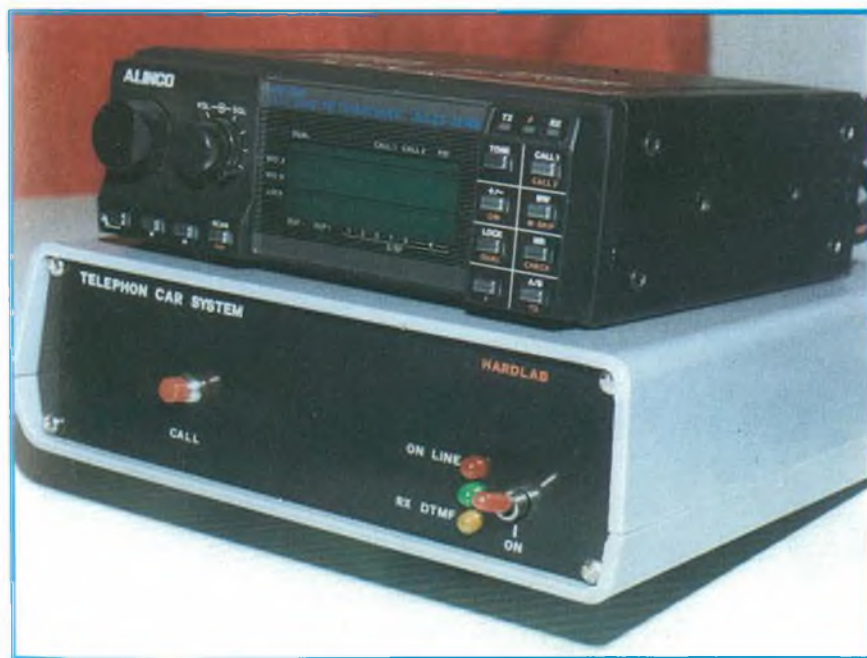
Foto 2. L'interfaccia andrà collegata ad un apparecchio ricetrasmittente possibilmente dual bander. Per le nostre prove abbiamo utilizzato una coppia di ALINCO ALD-24, gentilmente forniti dalla GBC Italiana.
