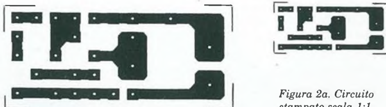
Figura 2. Circuito stampato in scala 2:1 dell'avvisatore di batteria scarica.
