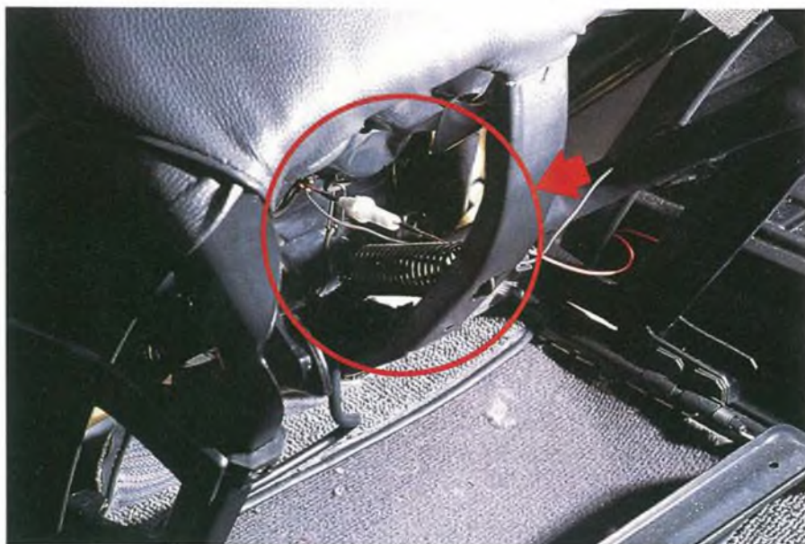
Foto 1. Fra le tante vetture su cui abbiamo montato il segnalatore, particolarmente versatile si è dimostrata la popolare "FIAT 126". Il foto è visibile la parte inferiore del sedile di guida. Come si può notare, il portafusibile è stato fissato tra le molle del sedile e un montante metallico del sedile stesso. Agendo in questo modo si evita l'inconveniente di "strappare" tutti i cablaggi durante le regolazioni della poltrona.
