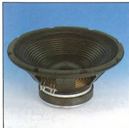
SUB WOOFER Potenza massima: 200 + 200 W Risposta in frequenza: 30 - 1.000 Hz Impedenza: 4 + 4 Ω Efficienza: 98 dB/W/m Peso magnete: 1100 g Dimensioni: ∅ 307 x 138 mm AC/6260-04
