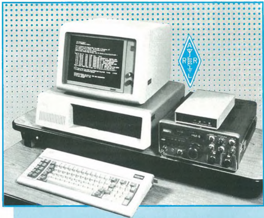
Figura 5. Un lungo terminale per RTTY - Packet e Dati costituito da un personal computer ed un compatto ricetrasmittitore VHF. Prowede all'interfacciamento il MODEM: la cassetina di color chiaro posta sul cofano dell'apparato radio. Il packet sta avendo un eccezionale sviluppo nelle gamme VHF ed UHF e si avvale per coprire distanze nazionali, d'una rete ad hoc con ripetitori chiamati: Digipeaters ossia "digital repeater".
