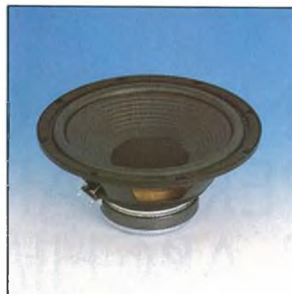
WOOFER Potenza massima: 120 W Risposta in frequenza: 30 - 10 000 Hz Impedenza: 4 Ω Efficienza: 92 dB/W/m Peso magnete: 570 g Dimensioni: ∅ 260 x 110 mm AC/6220-04
