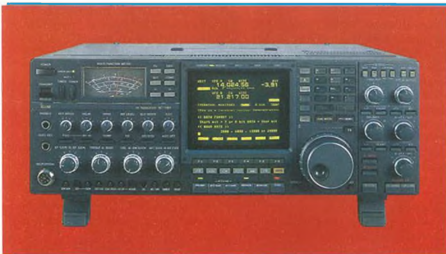
Figura 4. Uno dei più recenti prodotti giapponesi: lo ICOM "IC 781". È un ricetrasmittitore HF idoneo per qualsiasi tipo di comunicazione amatoriale. compresa la RTTY, la trasmissione-dati, il morse con manipolazione elettronica. Facilmente interfacciabile al computer, può essere comandato tramite esso.
