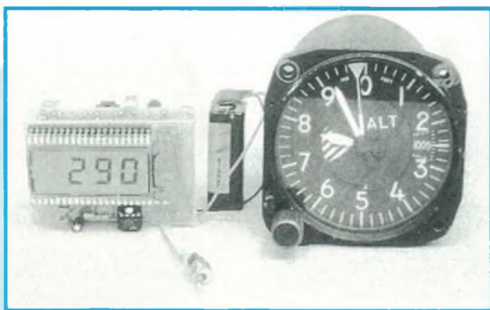
Figura 1. L'altimetro a valore massimo accanto all'analogo strumento utilizzato in un aeromobile sportivo. E' chiaramente rilevabile il risparmio di peso.
