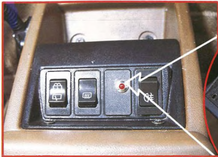
Foto 2. Il capo redattore della nostra consorella PCDISK si è gentilmente prestato al montaggio del segnalatore sul suo fuoristrada Nissan Patrol 3300 TD. Il prototipo è stato sistemato sul mobiletto centrale della vettura; in foto è visibile, a sinistra il risultato finale (è visibile solo il LED), a destra il montaggio della basetta all'interno del mobile.
