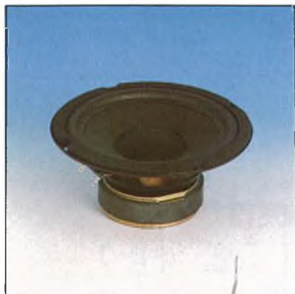
WOOFER Potenza massima: 80 W Risposta in frequenza: 60 - 12 000 Hz Impedenza: 4 Ω Efficienza: 90 dB/W/m Peso magnete: 380 g Dimensioni: ∅ 170 x 72 mm AC/6200-04
