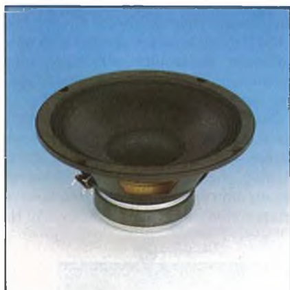
WOOFER Potenza massima: 150 W Risposta in frequenza: 30 - 2.500 Hz Impedenza: 4 Ω Efficienza: 95 dB/W/m Peso magnete: 770 g Dimensioni: ∅ 260 x 116 mm AC/6230-04
