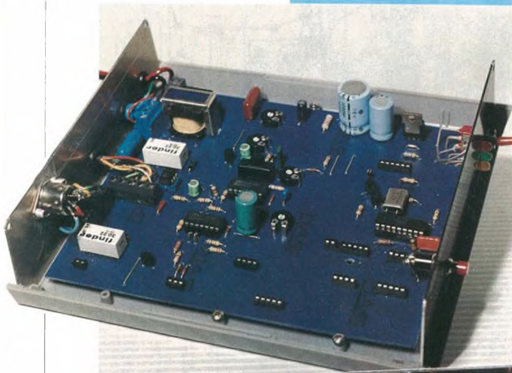
▲ Foto 2. L'interfaccia collegata ad un RTX bibanda; in foto è visibile l'apparecchio utilizzato per le prove, un ALINCO ALD-24, messo a disposizione dalla GBC Italiana.
