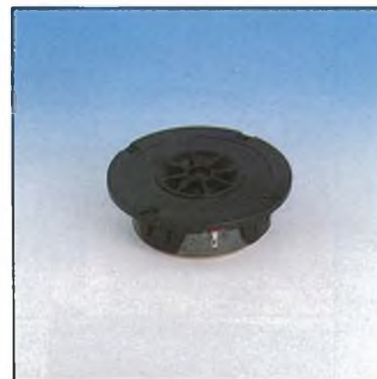
DOME TWEETER Potenza massima: 150 W (a 5 kHz) Risposta in frequenza: 2.500 - 20.000 Hz Impedenza: 4 Ω Efficienza: 96 dB/W/m Peso magnete: 240 g (al Bario) Dimensioni: ∅ 100 x 30 mm AC/6280-04
