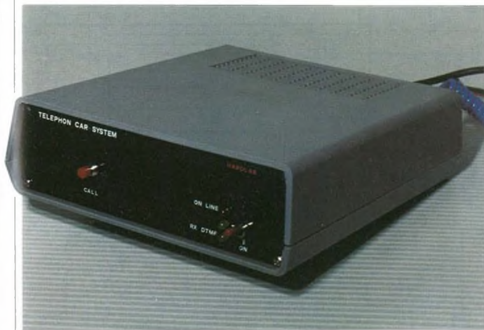
Foto 1. L'interfaccia telefonica come si presenta una volta montata all'interno di un mobiletto; anche se quello utilizzato per le prove era plastico, si consiglia di utilizzare un contenitore metallico, così da evitare rientri di radiofrequenza.
