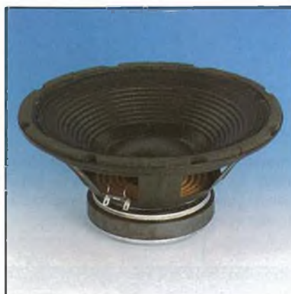
WOOFER Potenza massima: 200 W Risposta in frequenza: 30 - 2.500 Hz Impedenza: 4 Ω Efficienza: 97 dB/W/m Peso magnete: 1100 g Dimensioni: ∅ 307 x 138 mm AC/6240-04
