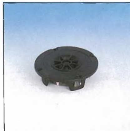
DOME TWEETER Potenza massima: 100 W (a 5 kHz) Risposta in frequenza: 2.500 - 20.000 Hz Impedenza: 4 Ω Efficienza: 93 dB/W/m Peso magnete: 110 g (al Bario) Dimensioni: ∅ 100 x 25 mm AC/6270-04
