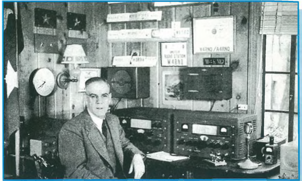
Figura 2. 1950 - una bella stazione del tempo con trasmettitore e ricevitore separati. Apparati Collins per telegrafia morse e fonia - modulazione d'ampiezza convenzionale. L'OM è W4RNQ della Virginia (USA).
