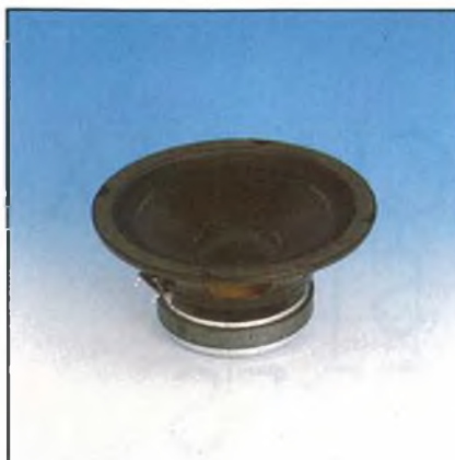
WOOFER Potenza massima: 140 W Risposta in frequenza: 40 - 2.500 Hz Impedenza: 4 Ω Efficienza: 94 dB/W/m Peso magnete: 570 g Dimensioni: ∅ 210 x 95 mm AC/6210-04
