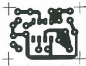
Figura 3. Circuito stampato scala 1:1.
