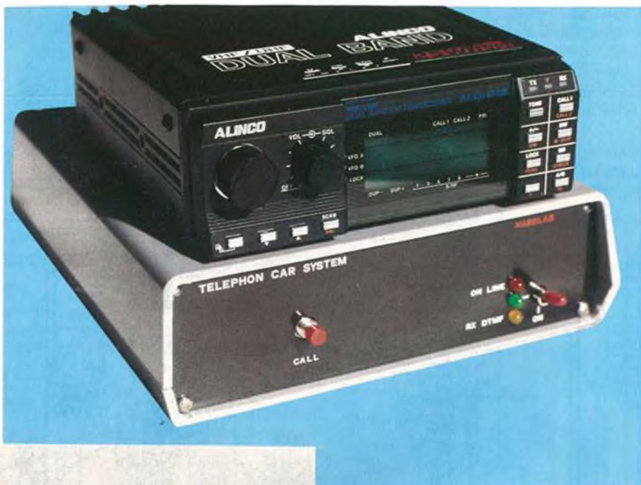
▲ Foto 2. L'interfaccia collegata ad un RTX bibanda; in foto è visibile l'apparecchio utilizzato per le prove, un ALINCO ALD-24, messo a disposizione dalla GBC Italiana.
