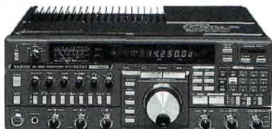
FT-767GX – TX décamétrique
