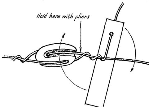
FIG. 3—USING A SIMPLE LEVER FOR TWISTING HEAVY GUY WIRES
