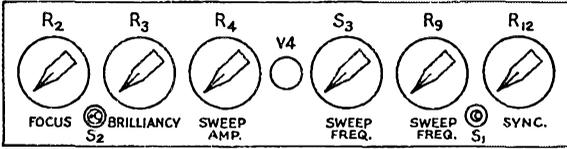
FIG. 2—CONTROL PANEL ARRANGEMENT OF THE OSCILLOSCOPE UNIT
