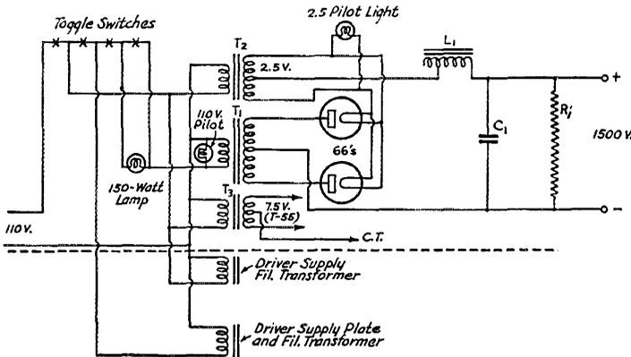
FIG. 2—THE POWER SUPPLY CIRCUIT
