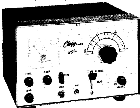
CLEGG 99'ER 6 METER TRANSCEIVER
